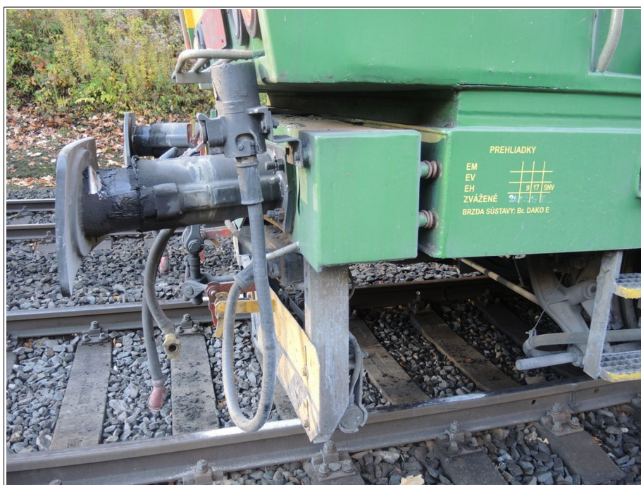
Obr. č. 6: Pohled na deformované nárazecí ústrojí a deformovaný přední (deformační) čelník HDV vedoucí sekce 131.043-2 po srážce s uvázlým vlakem Pn 62054.
