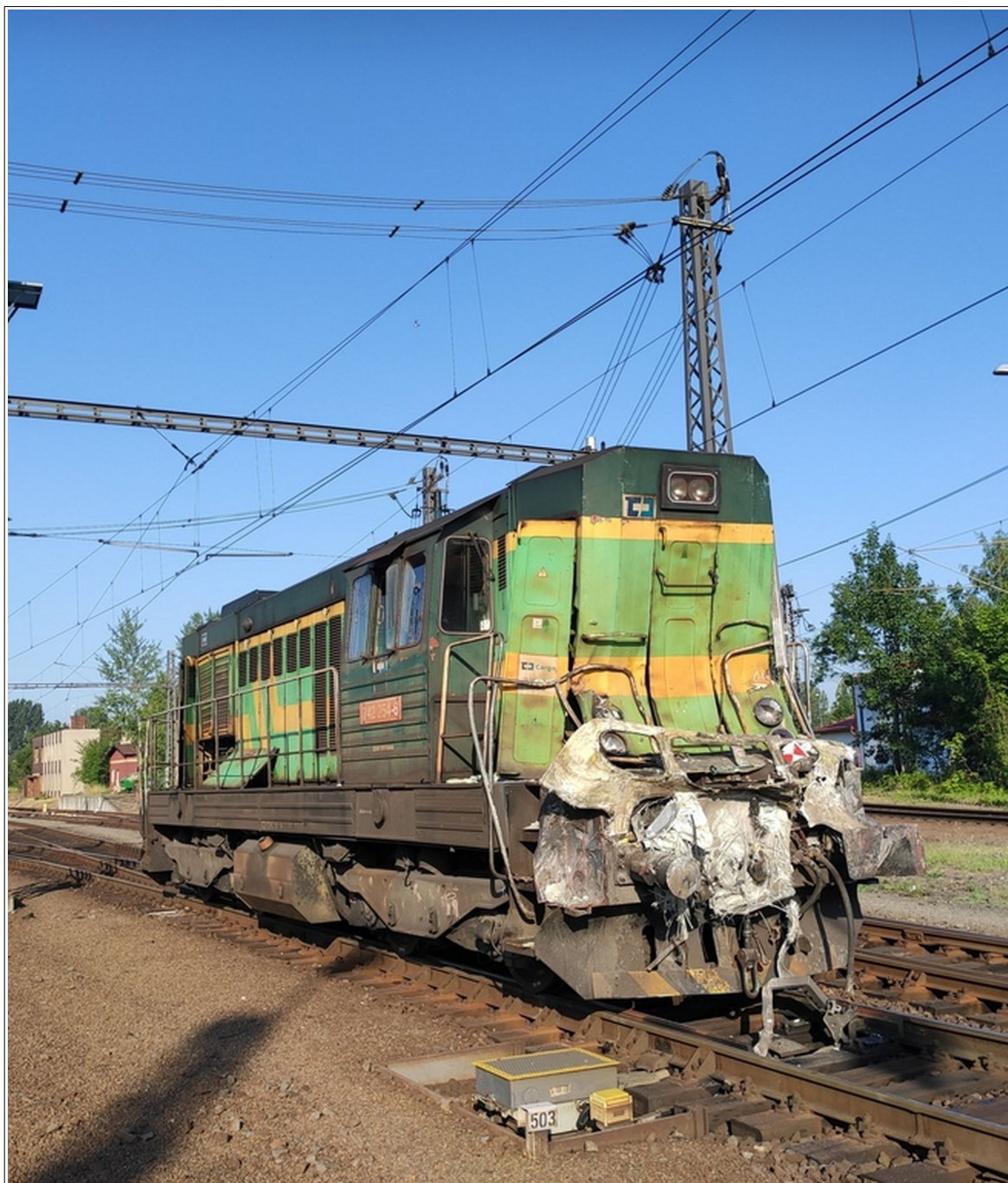
Obr. č. 9: Posunový díl ČDC tvořený samostatně jedoucím HDV 742.254-6 v konečném postavení po srážce s vlakem Ex 516. Na poškozeném čelníku se nacházely kompozitové části předního čela hlavového DV 681.006-3 vlaku Ex 516.
