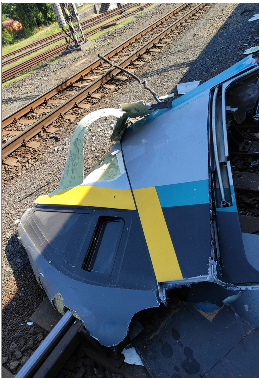
Obr. č. 8: Utržená část pravé skořepiny kabiny strojvedoucího a pravé bočnice hlavového DV 681.006-3 vlaku Ex 516, jež se nacházela v odbočné větvi výhybky č. 57
