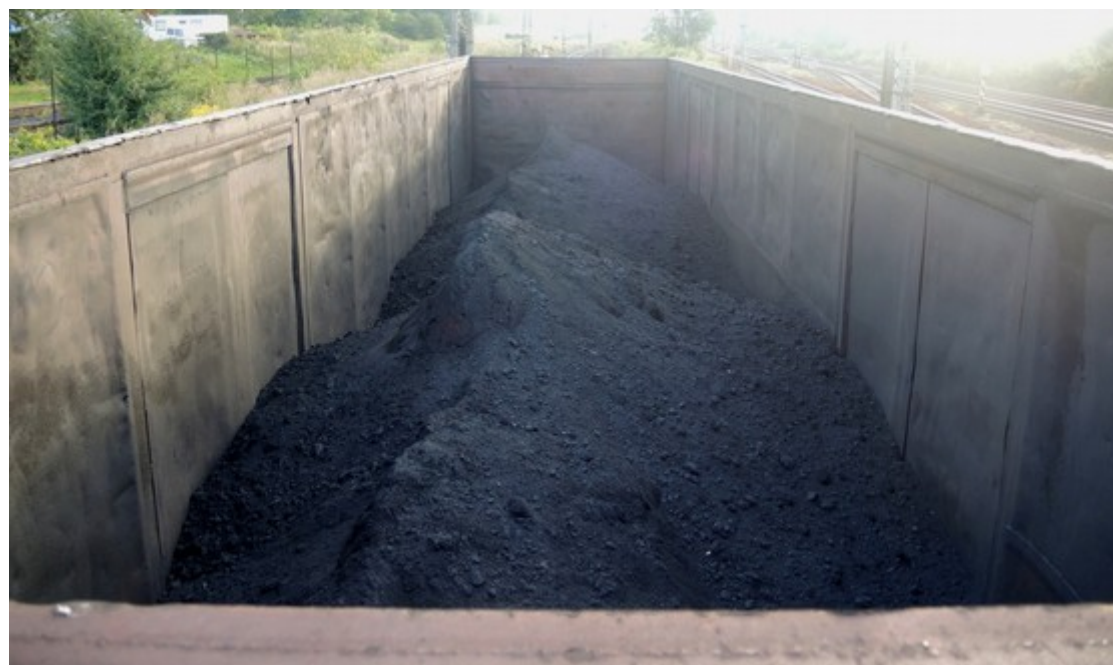
Obr. č. 7, 8: Příklad nerovnoměrného rozložení práškového koncentráту železné rudy na ložných plochách vysokostěnných TDV 31 54 5949 664-4 řady Eas 107.11 (snímek pořízený ve směru jízdy taženého posunového dílu) a 31 54 5968 296-1 řady Eas 107.5 (snímek pořízený proti směru jízdy taženého posunového dílu), zařazených jako 41. a 42. TDV za HDV. Všechna ostatní TDV byla přepravovaným zbožím naložena obdobně.
