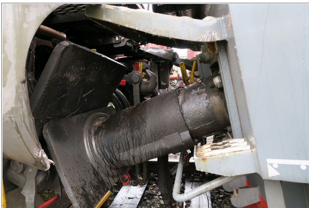
Obr. č. 4: Detailní pohled na poškozená narážecí ústrojí obou HDV následkem MU.
