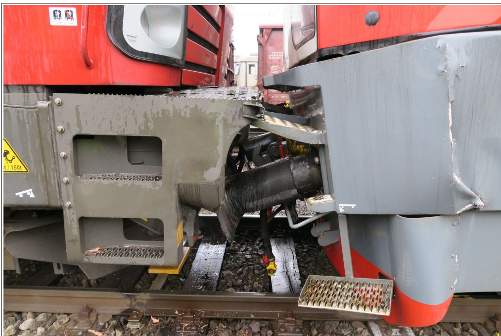
Obr. č. 3: Pohled na poškozená čela obou HDV následkem MU.
