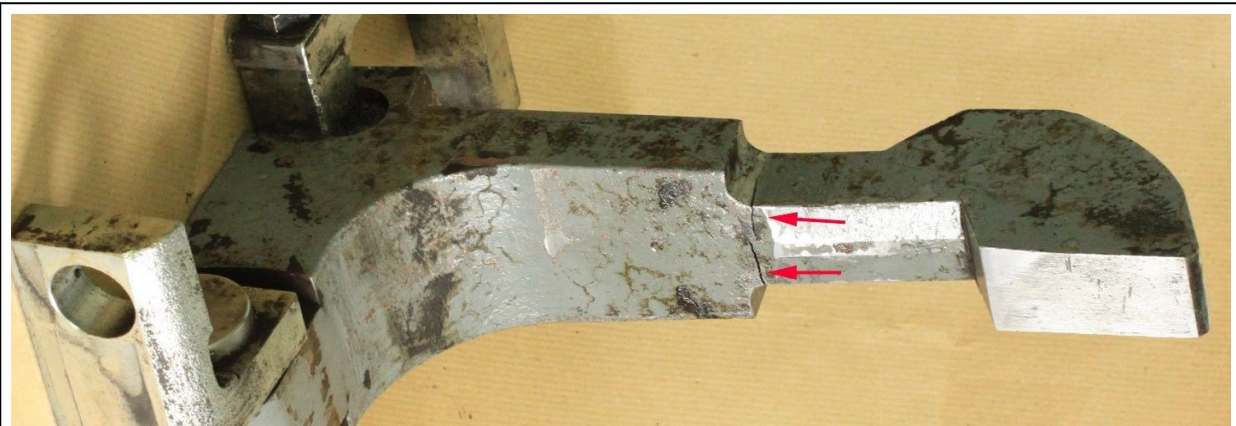
Obr. č. 4: Závěrný hák z čelistového závěru výhybky č. 170b1 v Kolíně. Poloha trhliny je vyznačena šipkami. Zdroj: ČVUT
