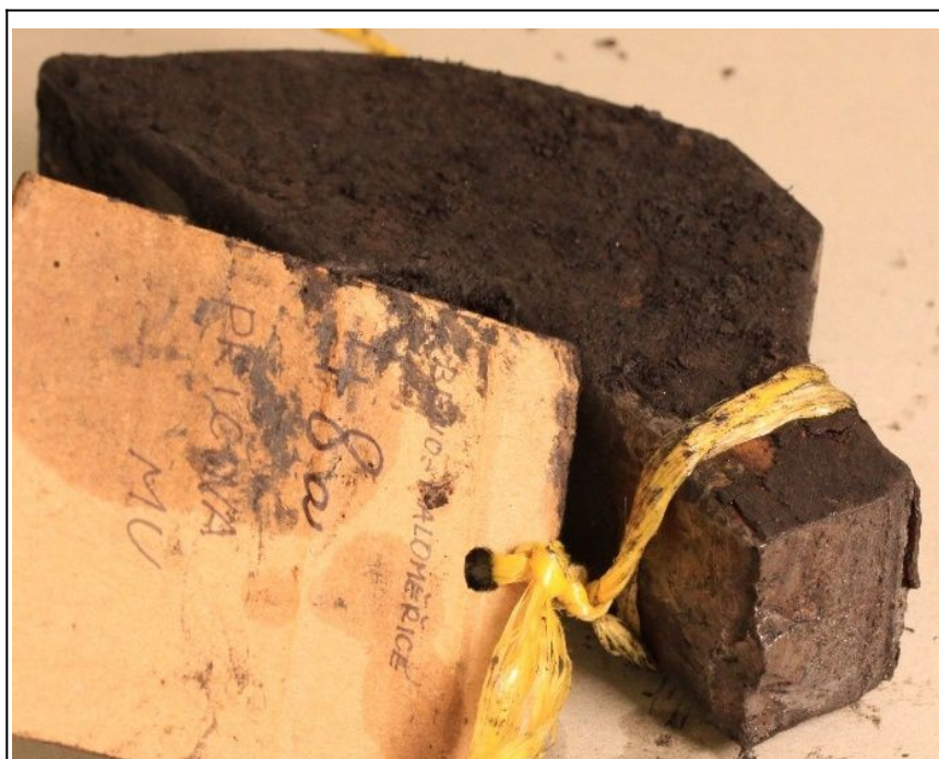
Obr. č. 2: Odlomená část závěrného háku z čelistového závěru výhybky č. 48a Zdroj: ČVUT
