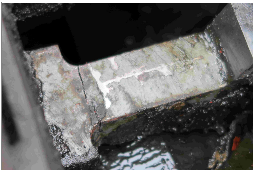
Obr. č. 11: Nálezový stav háku výhybky č. 170b1 s nálomem v žst. Kolín po očištění od maziva a dalších nečistot Zdroj: DI
