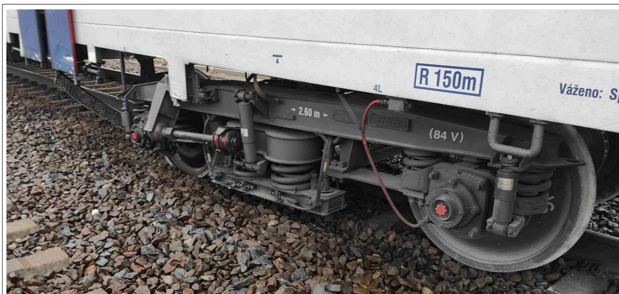
Obr. č. 4: Pohled na vykolejený druhý podvozek prvního TDV
