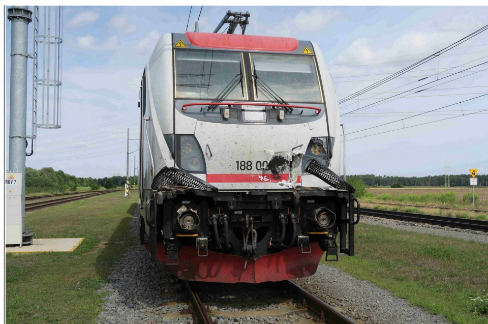
Obr. č. 5: Poškozené čelo HDV 188.003-8 řazeného za posunovacím HDV
