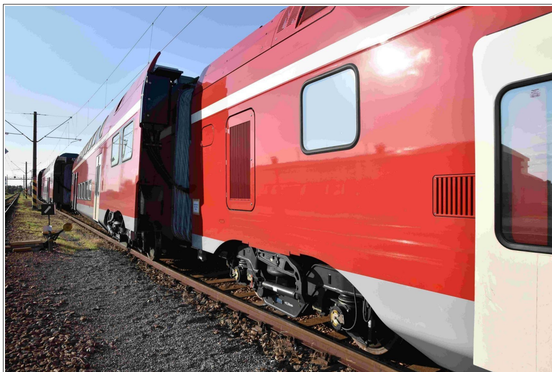
Obr. č. 2: Vykolejená 1. jednotka Stadler KISS
