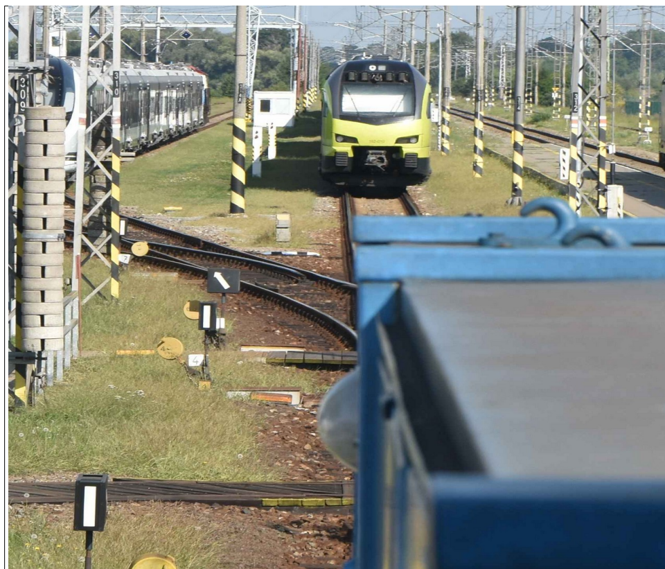
Obr. č. 4: Pohled z HDV řady 731 od dopravní kanceláře směrem k výhybce č. 7 (vlevo od HDV), kdy již bylo možno rozeznat postavení jazyků a začalo být viditelné výměnné návěstidlo této výhybky (vlevo u sloupu trakčního vedení)
