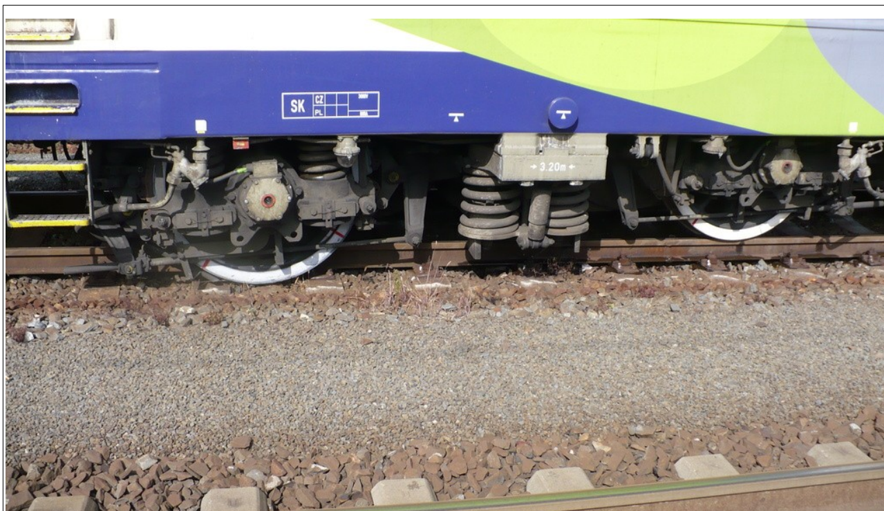
Obr. č. 2: Pohled na vykolejený přední podvozek HDV koncové sekce 131.064-8 v konečném postavení po MU Zdroj: SŽ
