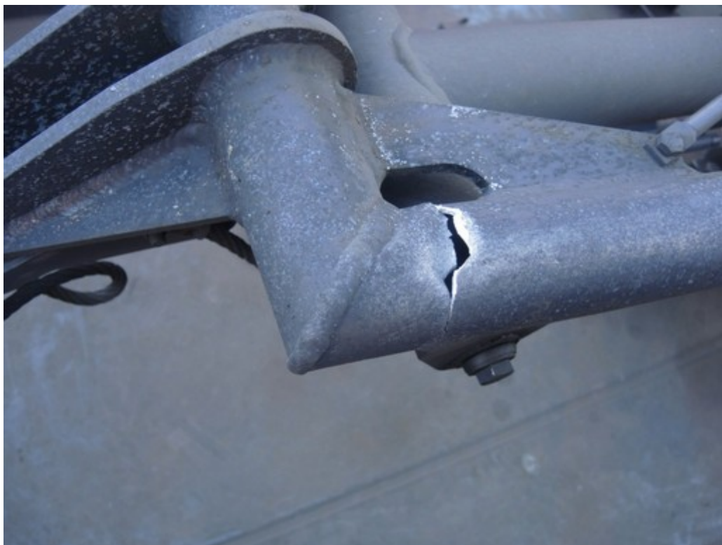
Obr. č. 6: Prasklina v konstrukci pantografu HDV po srážce s izolátorem
