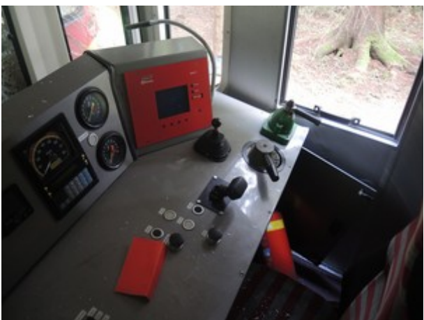
Obr. č. 6: Detail stanoviště strojvedoucího HDV č. 90 54 3 805 901-6 Zdroj:DI
