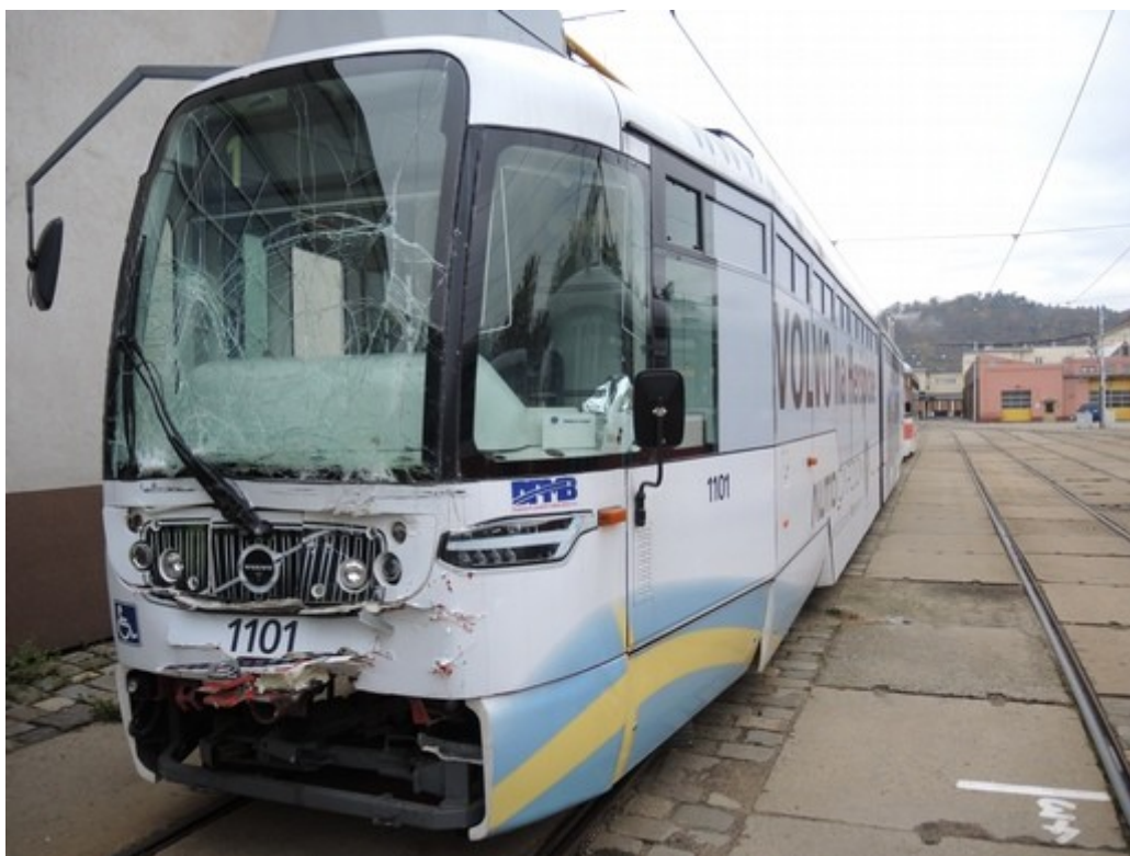
Obr. č. 7: Poškození odbočující tramvaje linky č. 1, kurz 17
