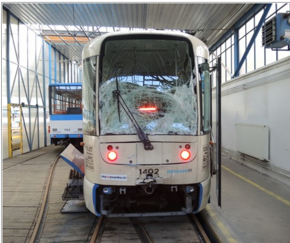
Obr. č. 3: Plně funkční označení konce TVL se třemi červeně svítícími světly upozorňující na zadní část TVL a aktivaci brzdového systému DV.
