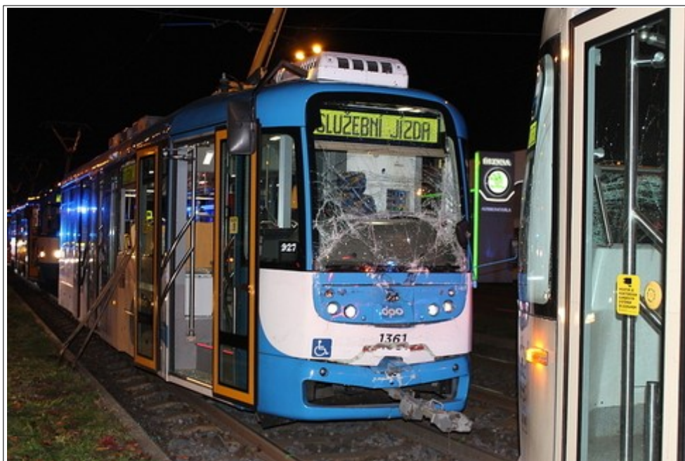
Obr. č. 1: Pohled na přední čelo TVL linky č. 915011, kurz 105, v konečném postavení po MU.
