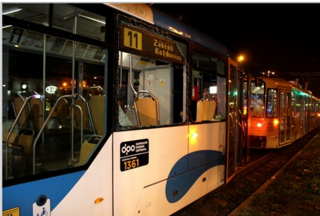
Obr. č. 7: Pohled na následkem srážky DV rozbitou skleněnou výplň pravého bočního okna DV TVL linky č. 11, kurz 105, a část zadního čela DV TVL linky č. 4, kurz 105.
