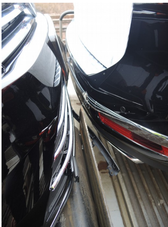
Obr. č. 5: Detail poškození přepravovaných OA na 1. TDV
