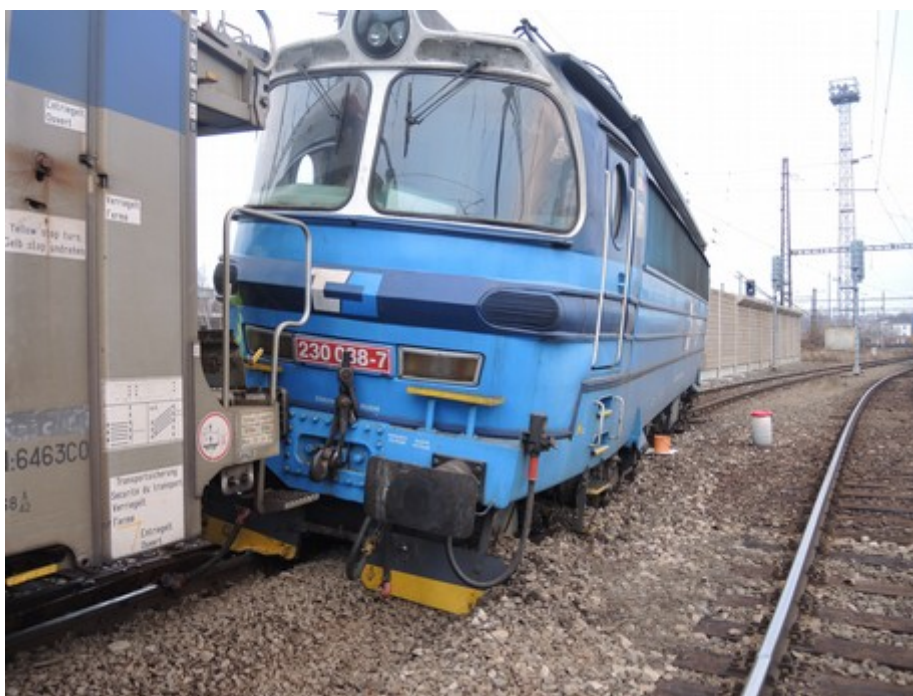
Obr. č. 1: Vykolejené HDV
