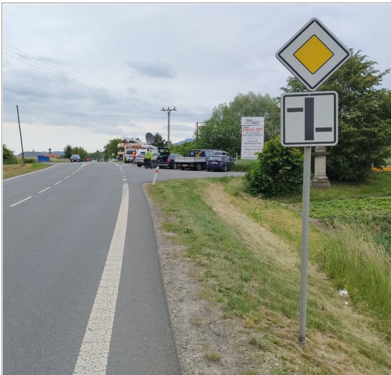
Obr. č. 13: Svislá dopravní značka P 2 „Hlavní pozemní komunikace“ doplněná o dodatkovou tabulku E 2b „Tvar křižovatky“ s vyznačenou vedlejší komunikací – účelovou komunikací Zdroj: DI
