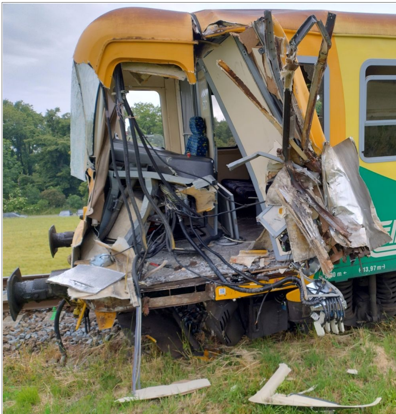
Obr. č. 11: Detailní pohled na poškozenou kabinu strojvedoucího a skříň ŘDV vlaku Os 3902 po vzniku MU Zdroj: DI
