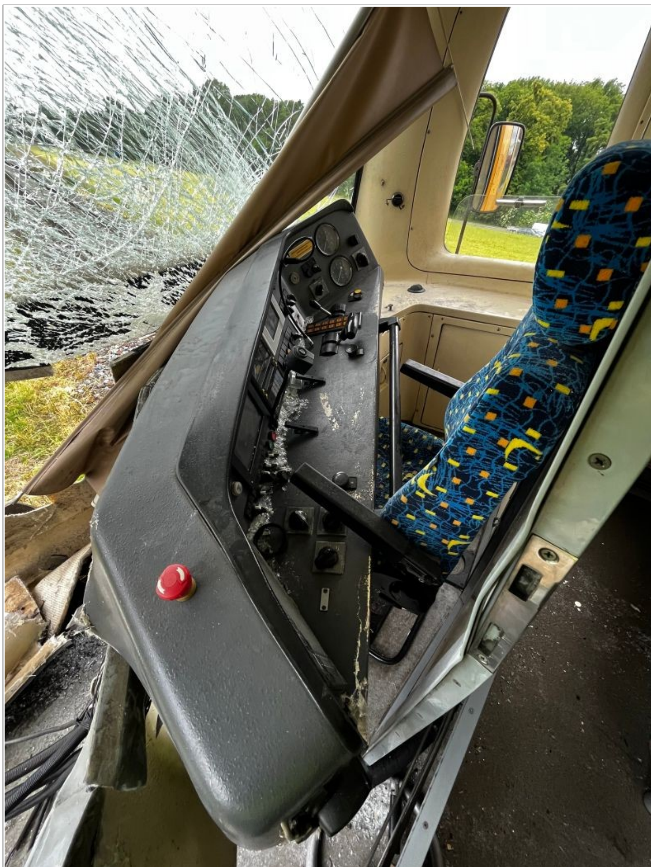
Obr. č. 10: Pohled na stanoviště strojvedoucího ŘDV vlaku Os 3902 po vzniku MU
