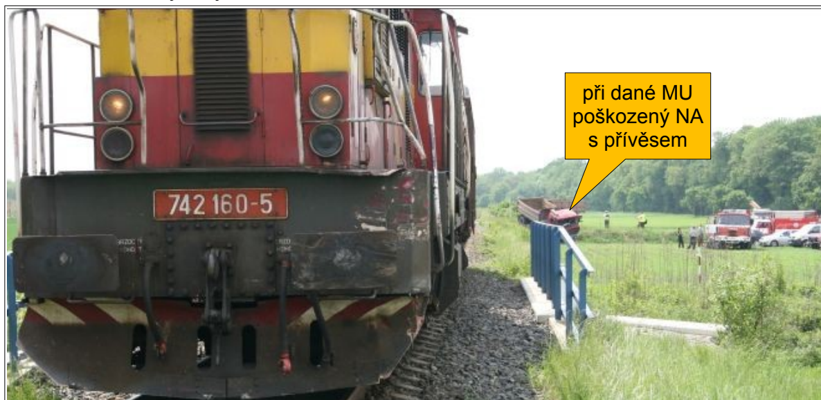
Obr. č. 4: Pohled na poškozené přední čelo HDV vlaku Mn 81055 a na poškozený NA s přívěsem v důsledku střetnutí na ŽP P7263 ze dne 11. 5. 2009. Zdroj: DI
