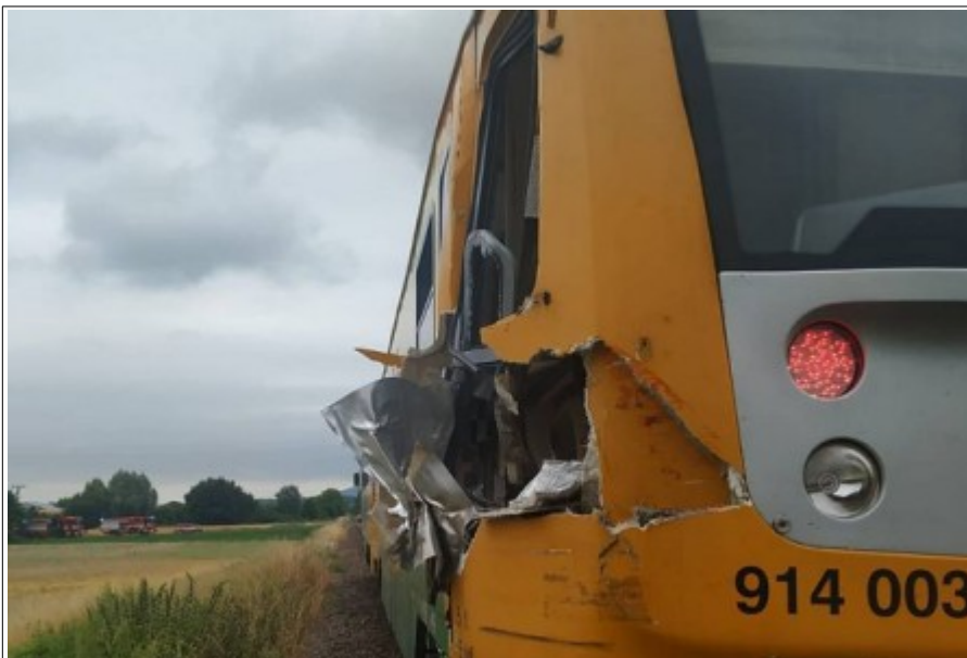
Obr. č. 6: Pohled na poškozené přední čelo vlaku Os 3912 v důsledku střetnutí s NA na ŽP P7263 dne 9. 7. 2021 Zdroj: HZS ZLK
