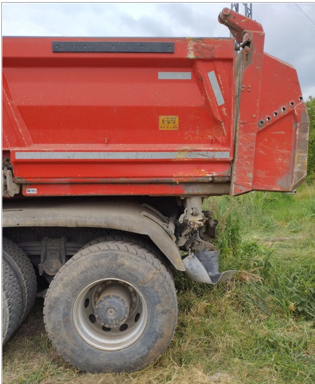
Obr. č. 12: Pohled na zadní část korby NA, do které narazilo přední čelo ŘDV vlaku Os 3902 Zdroj: DI
