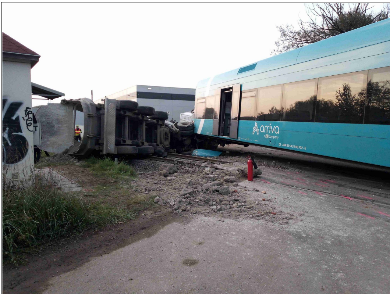
Obr. č. 2: Pohled na vykolejené KŘV-B 948.702-6 vlaku Os 14342 zaklíněné do převráceného tahače NA.
