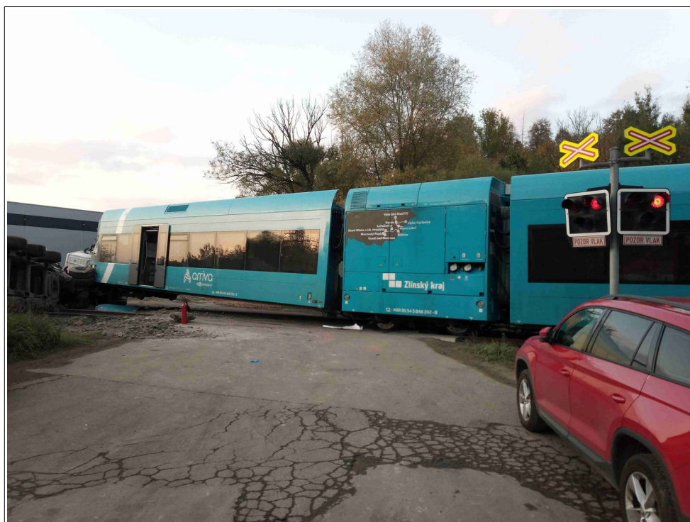
Obr. č. 5: Pohled na vykolejené DV vlaku Os 14342 v konečném postavení po MU. Zdroj: DI
