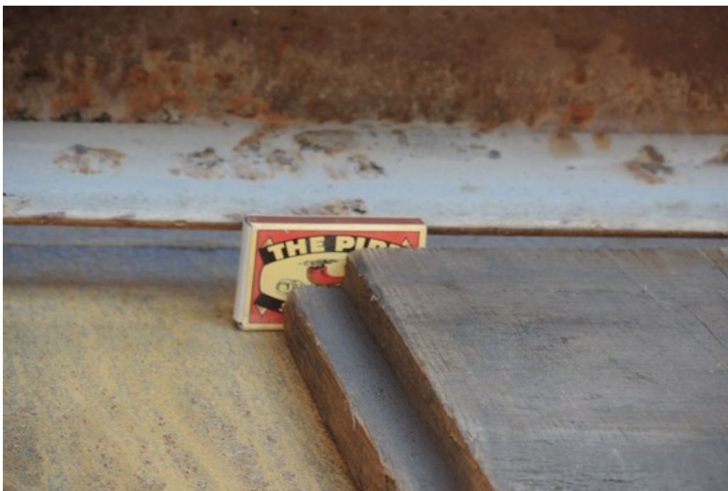
Obr. č. 6: Stav otevření výsypné klapky při ověřovacím pokusu dne 7. 12. 2017 v žst. Tišnov při porovnání s krabičkou zápalek o výšce 37 mm u TDV 81 54 6996 454-9
