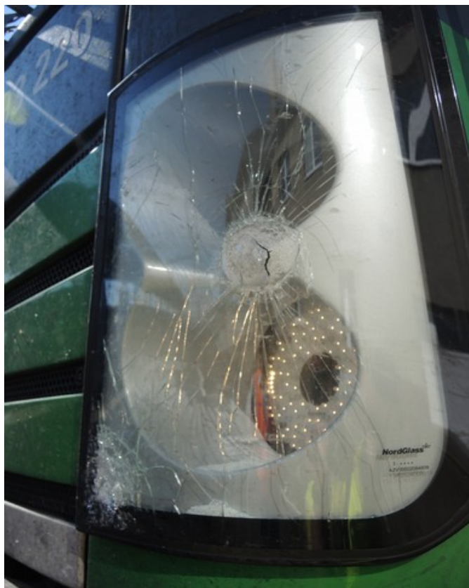
Obr. č. 13: Detail poškození krytu levého pozičního světla u HDV 193 220-1 D-ELOC
