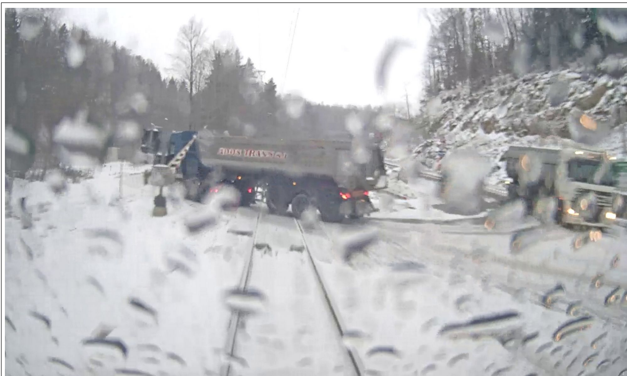
Obr. č. 8: Snímek ze záznamu kamery umístěné na čele DV vlaku Os 7153. Pohled na ŽP P4073 a uvážený NA těsně před střetnutím Zdroj: LET, úprava DI
