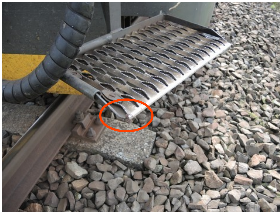
Obr. č. 1: Stupačka se stopami po zachycení oděvu zaměstnance
