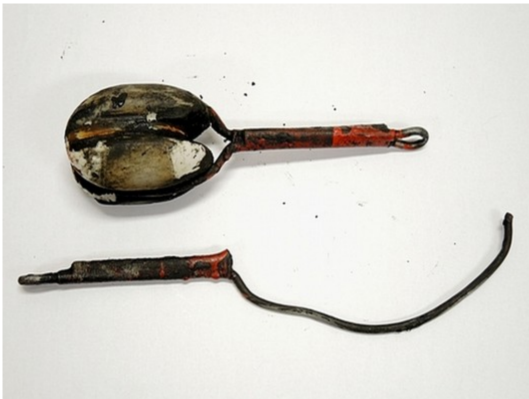
Obr. č. 7: Přetržený drátovod a izolační spojka
