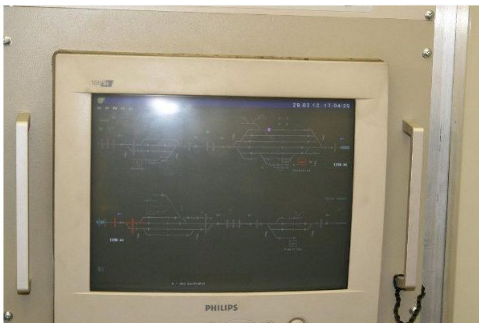
Foto 7: Zobrazení vlakové cesty pro vlak R 1195 na JOP žst. Blatno u Jesenice po vzniku MU
