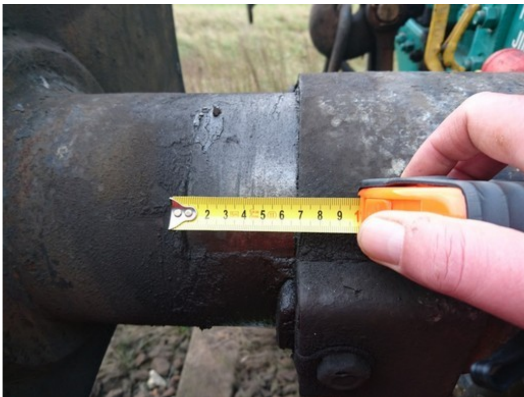
Obr. č. 4: Stopy po srážce vlaků na nárazníku čela HDV vlaku Pn 53973
