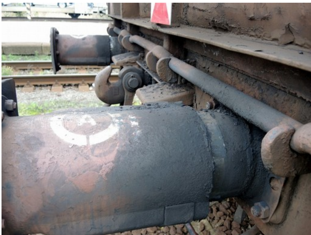
Obr. č. 5: Stopy po srážce na nárazníku posledního vozu vlaku Pn 66021
