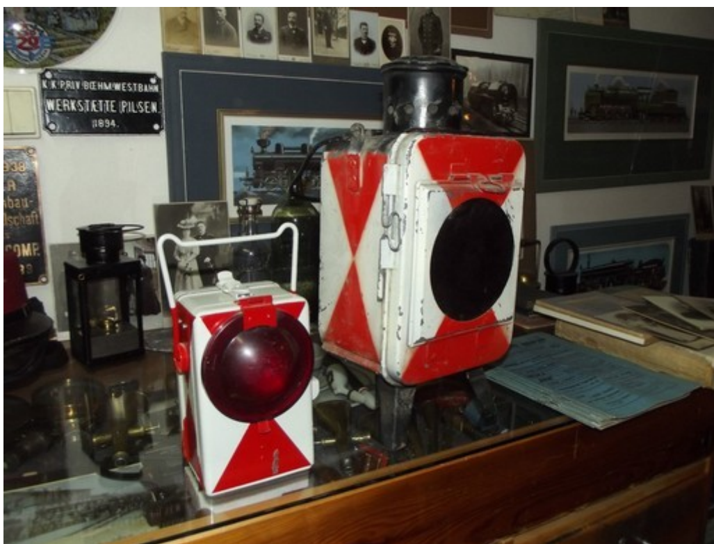
Obr. č. 3: Bateriové (vlevo) a petrolejové koncové světlo ze sbírky V. Simbartla
