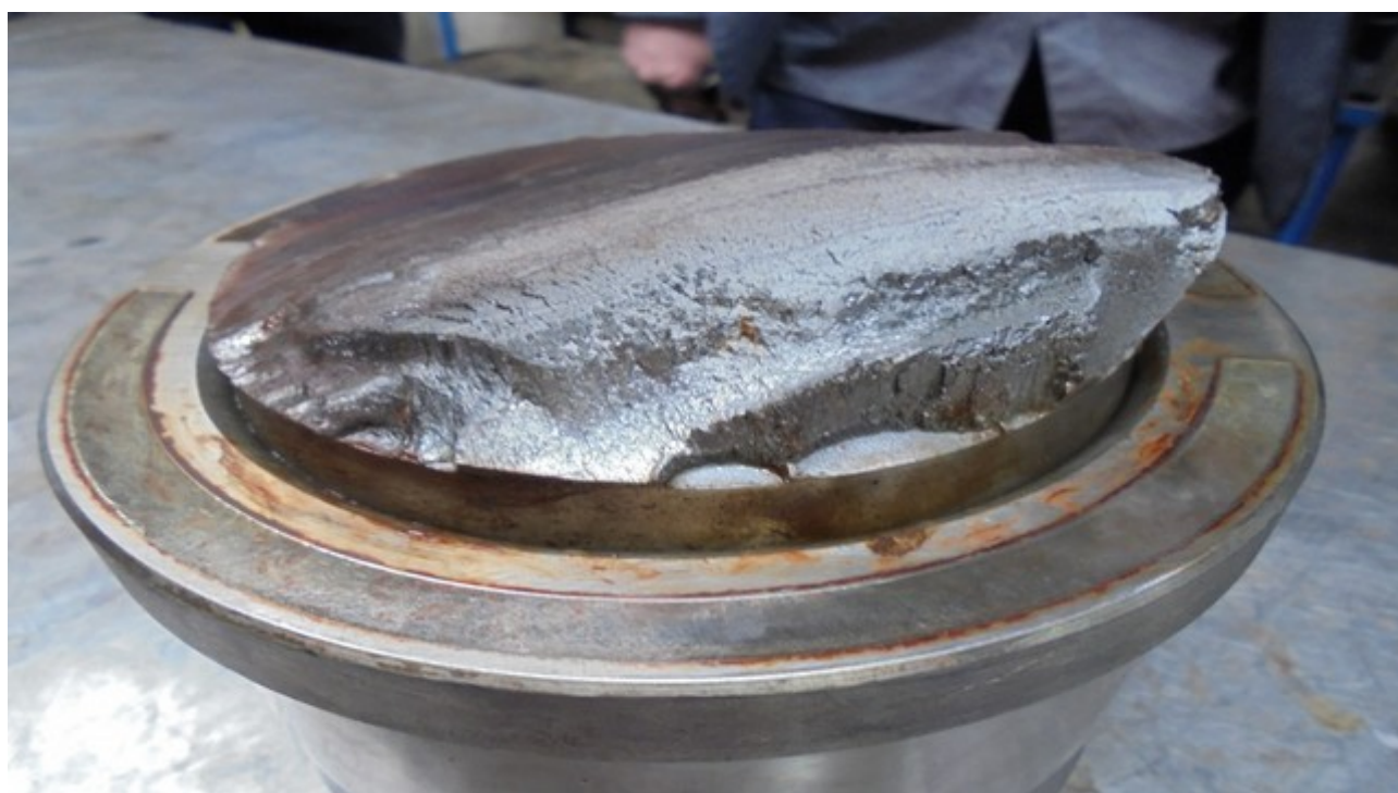
Obr. č. 13: Detail lomu čepu po vyjmutí z ložiskové komory a po umytí
