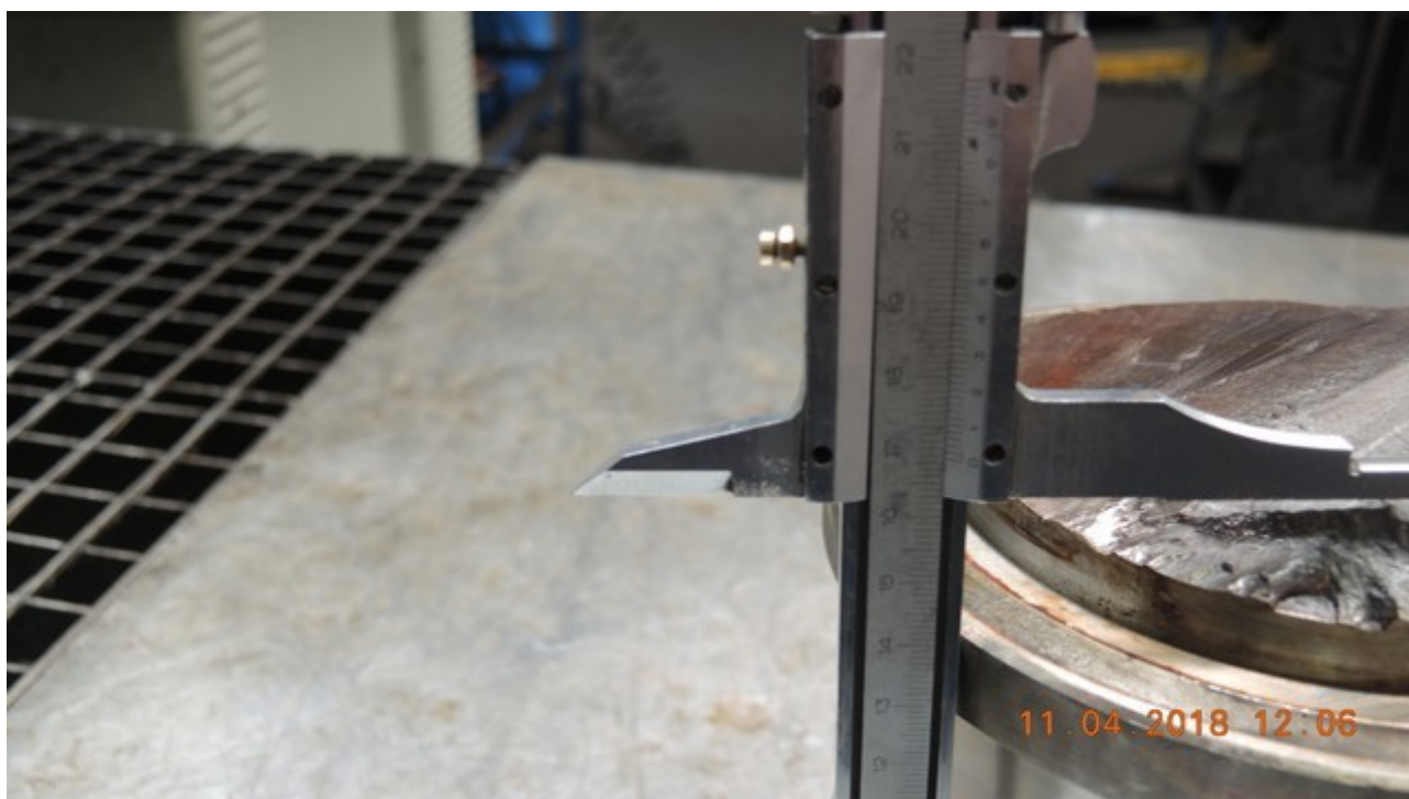
Obr. č. 12: Délka ulomeného čepu 160,85 mm
