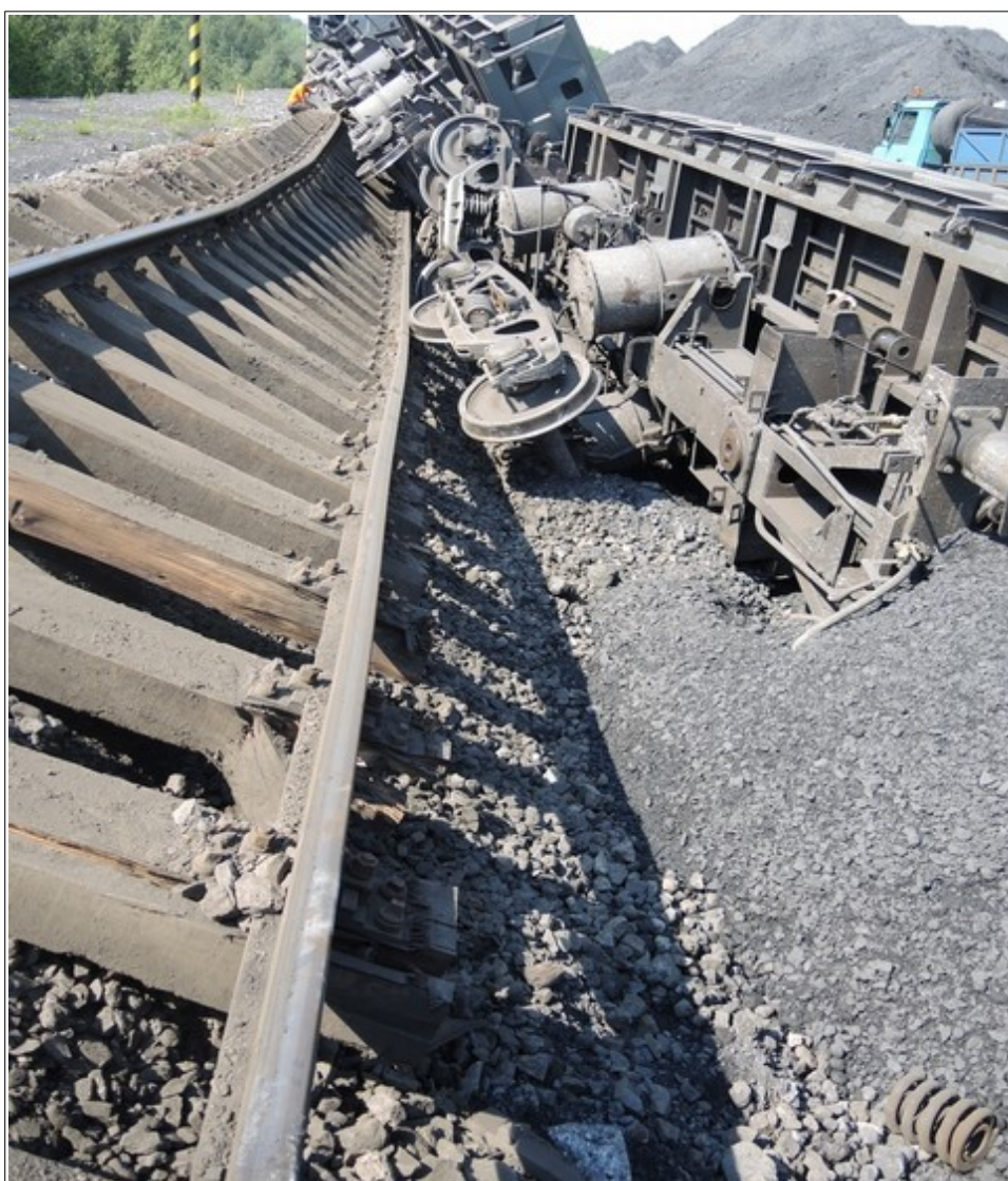
Obr. č. 1: Pohled na vykolejená DV po vzniku MU.
