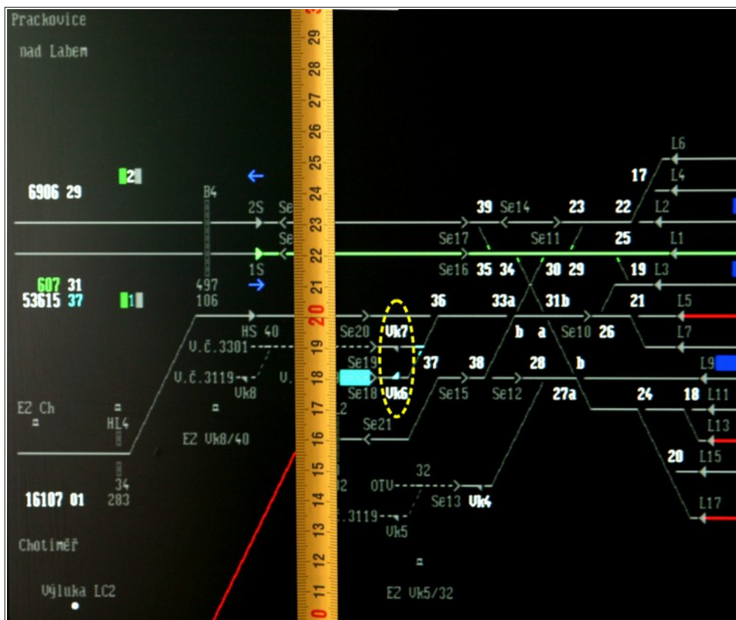
Obr. 5: Snímek monitoru SZZ žst. Lovosice dokumentující vzájemnou vzdálenost ikon výkolejek Vk 6 a Vk7 a seřadovacích návěstidel Se18 a Se19.
