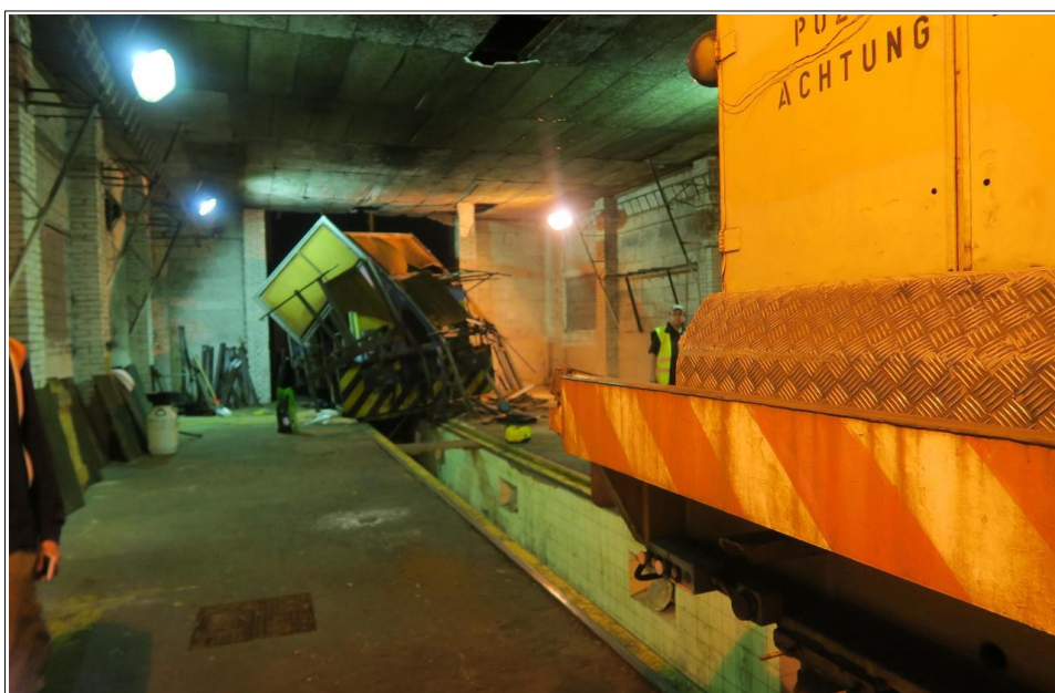
Obr. č. 1: Pohled na přední čelo vykolejeného HDV 704.519-8 a nárazem posunuté SDV SUM 1000 v konečném postavení po MU v hale Malá výtopna II. část vlečky „TSS Lovosice“.
