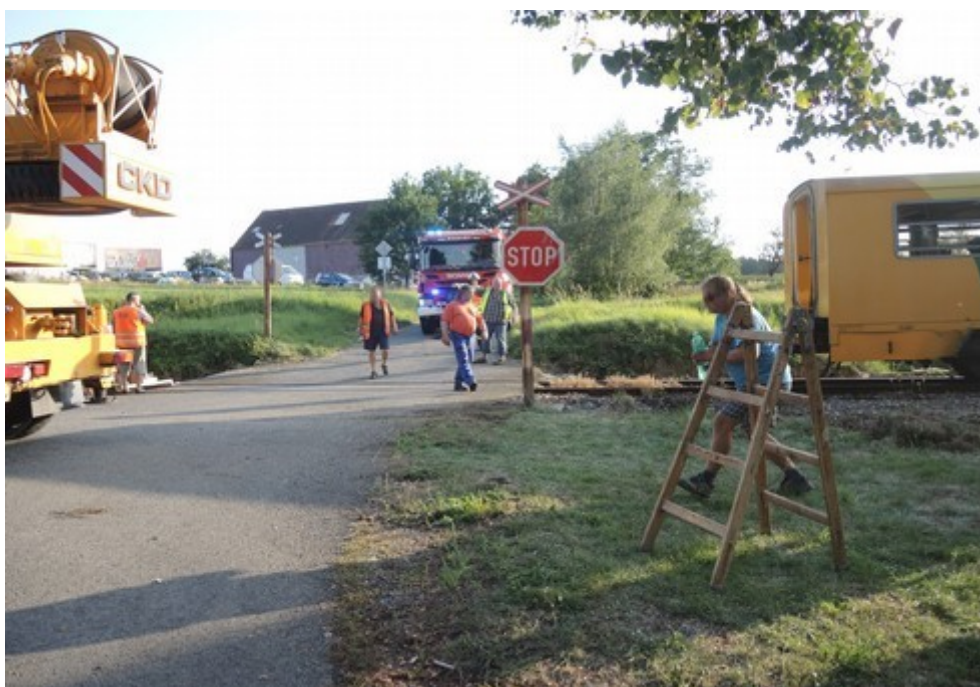
Obr. č. 4: Délka rozhledu D_z pro zastavení silničního vozidla ze směru jízdy traktoru
