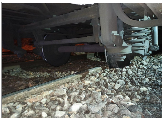
Obr. č. 3: Vykolejený podvozek TDV 93-29 020-7 Zdroj: DI
