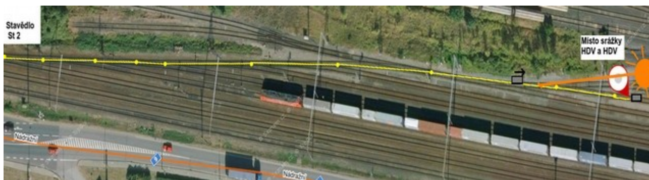
Obr. č. 3: Schéma jízdy posunového dílu a poloha slunce před MU
