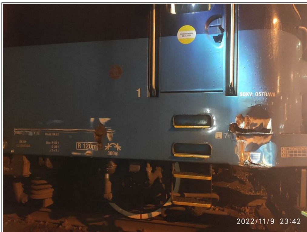
Obr. č. 6: Poškození HDV vlaku Nex 55530
