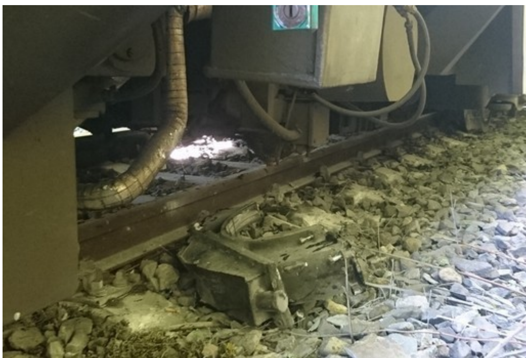
Obr. č. 6: Poškozený kryt převodu trakčního motoru HDV
