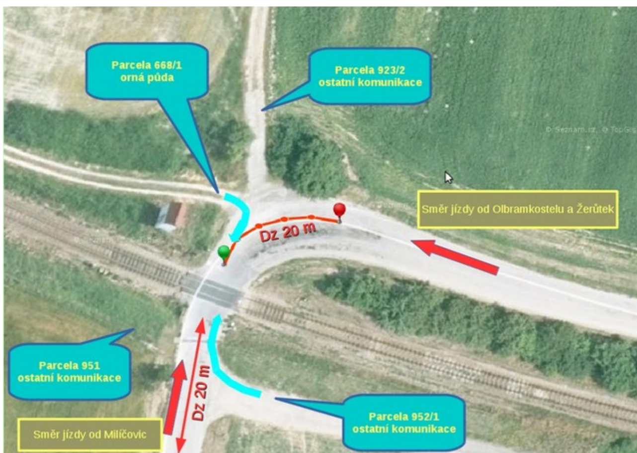
Obr. č. 6: Napojení účelových komunikací před přejezdem
