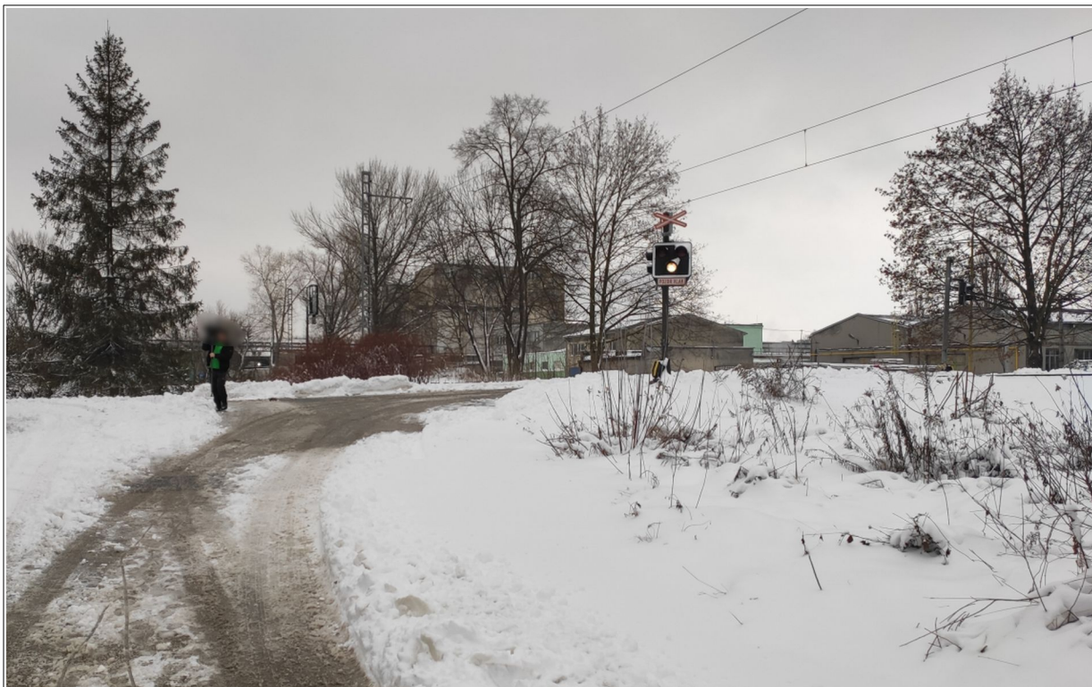
Obr. č. 2: Pohled na výstražník ve směru jízdy OA ze vzdálenosti 30 m před ŽP P7724, tj. ze vzdálenosti nejmenší předepsané délky rozhledu pro zastavení D_z před ŽP
