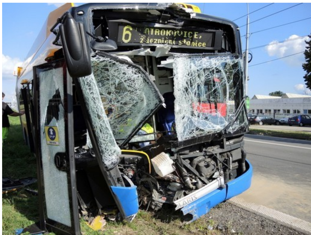
Obr. č. 7: Poškození čelní části trolejbusu
