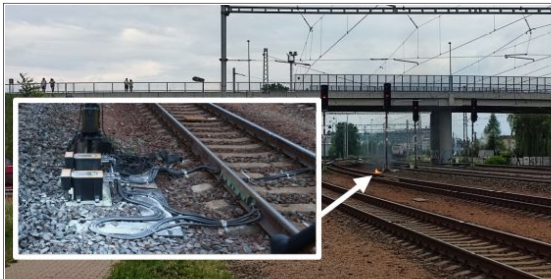
Obr. č. 11: Pohled na hořící odjezdové návěstidlo L3a žst. Otrokovice. Snímek ve výřezu dokumentuje stav stykových transformátorů a lanových propojení po vzniku MU a následném zásahu HZS. Zdroj: K-report.net a SŽ
