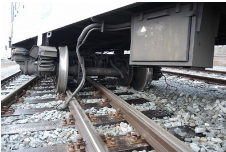
Obr. č. 3: Vykolejené nápravy předního podvozku „a“
