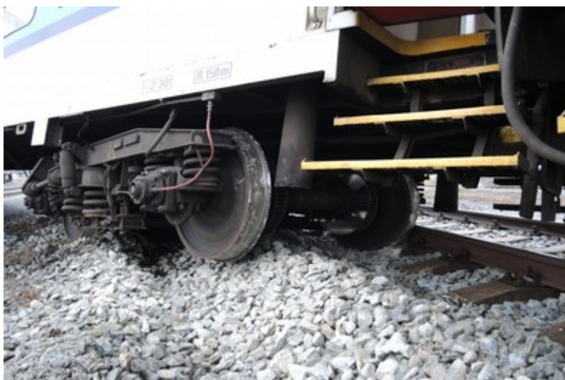
Obr. č. 4: Vykolejený zadní podvozek „b“
