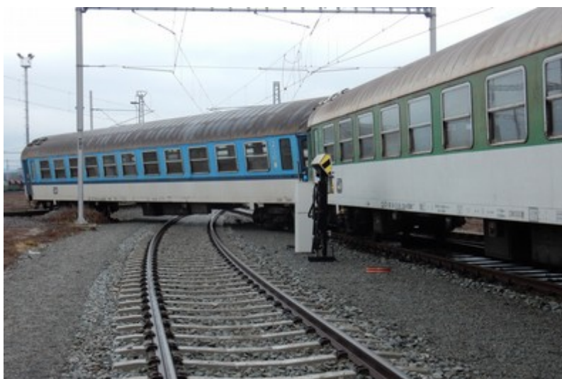
Obr. č. 5: Pohled na vykolejené drážní vozidlo
