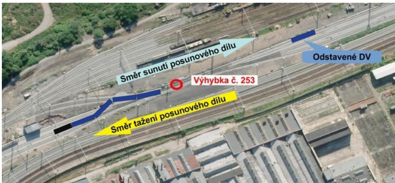
Obr. č. 2: Schéma místa vzniku MU
