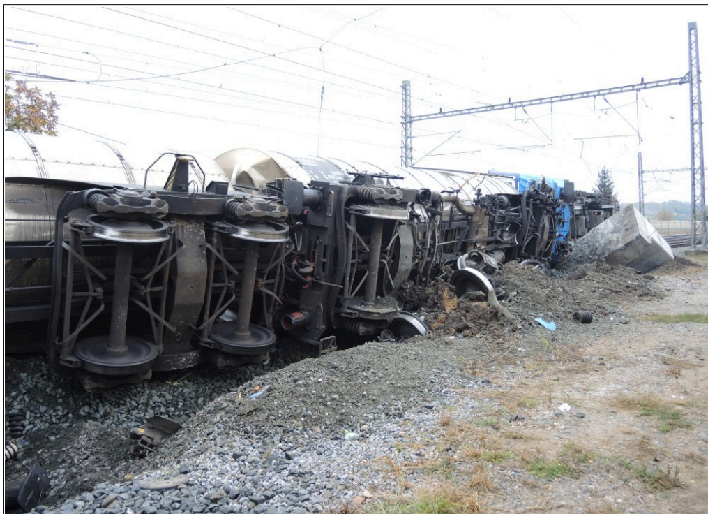
Obr. č. 6: Zdemolované betonové zarážedlo kusé SK č. 4a a vykolejená DV
