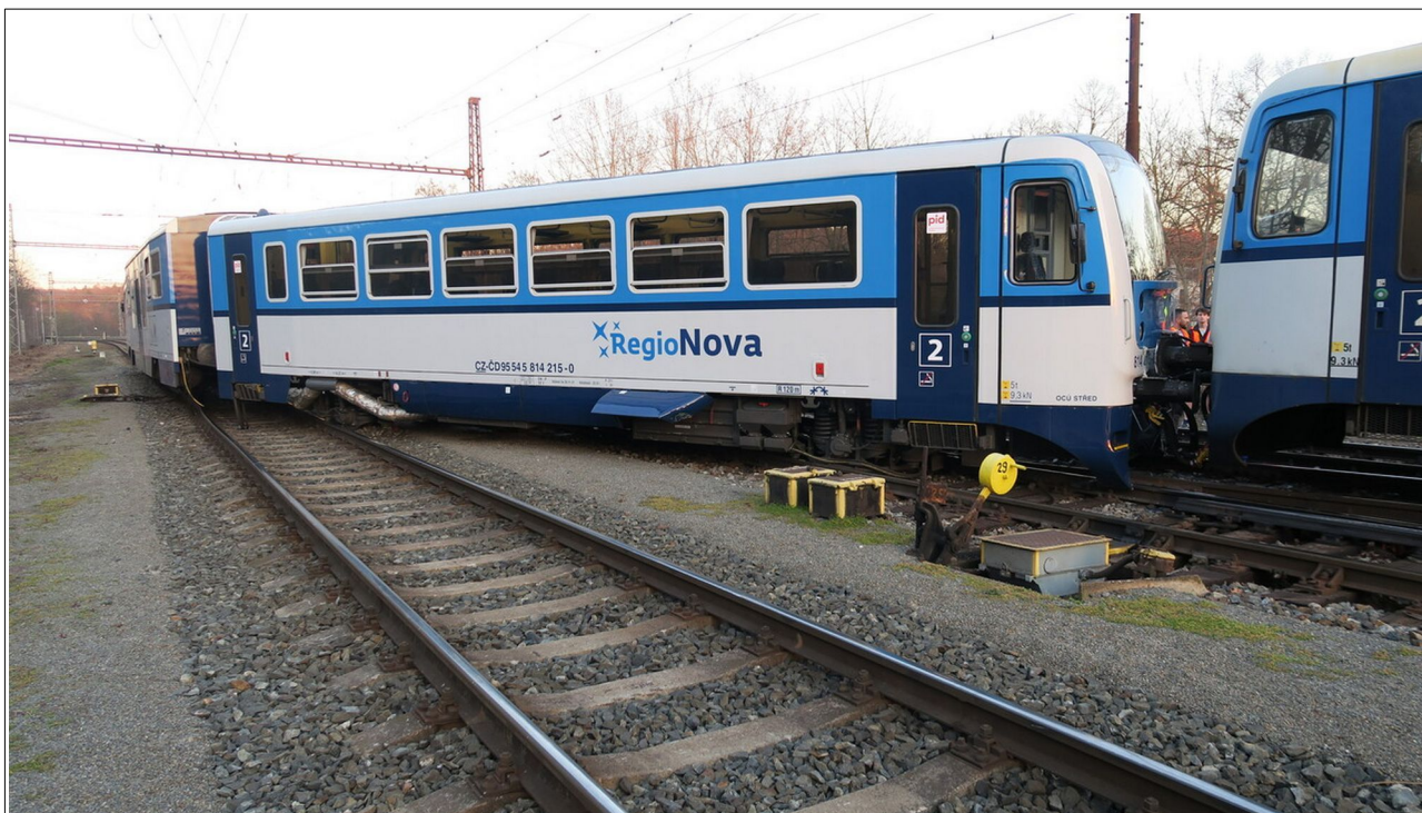
Obr. č. 5: Snímek vykolejeného HDV 814.215-0 v konečném postavení po MU, pořízený z prostoru vedle SK č. 1b. Zdroj: DI
