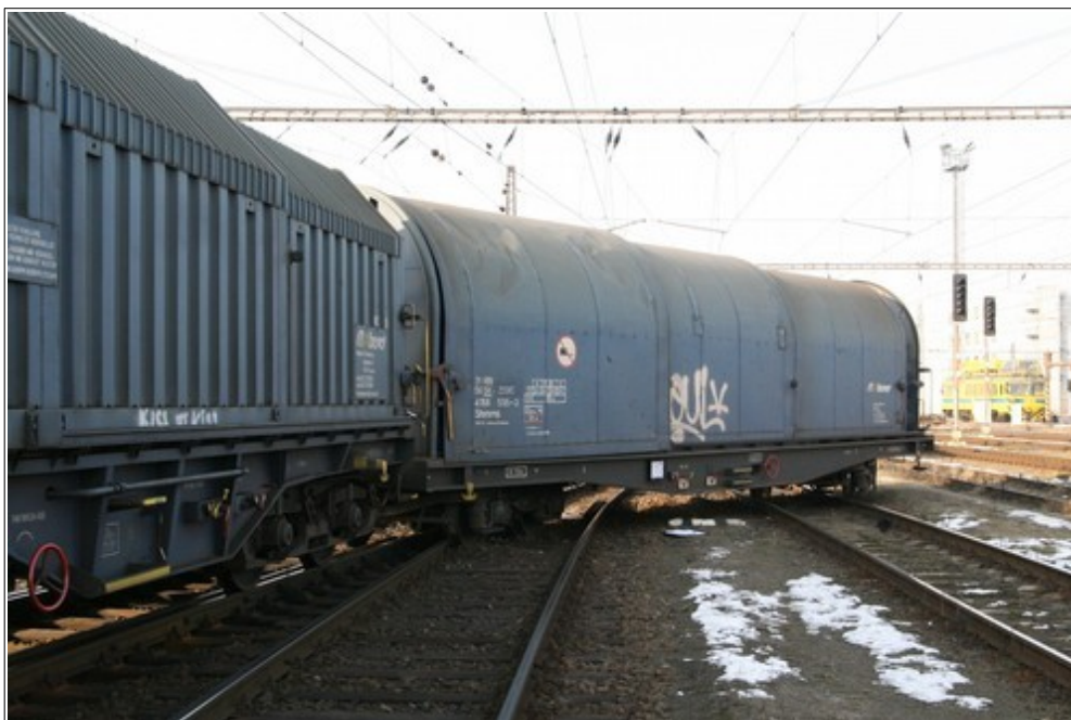
Obr. č. 6: Pohled na vykolejené TDV 31 56 4768 555-3.
