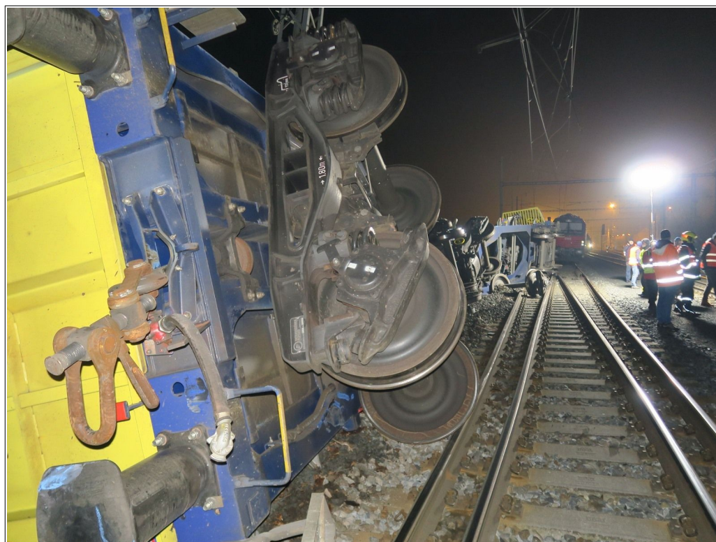
Obr. č. 6: Pohled na vykolejená TDV vlaku Pn 52479
