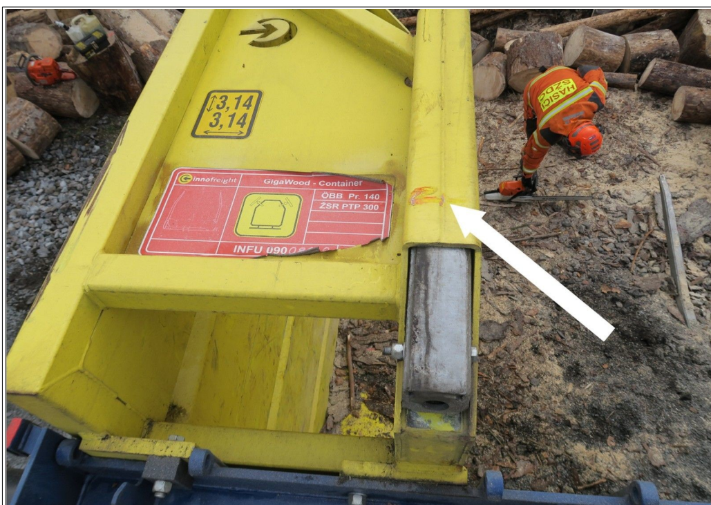
Obr. č. 8: Pohled na 1. klanici vlevo předního dílu (části „b“) 4. TDV 37 80 4657 019-8 vlaku Pn 52479 s 1. stopou vzniklou srážkou s HDV vlaku Nex 43404 Zdroj: DI
