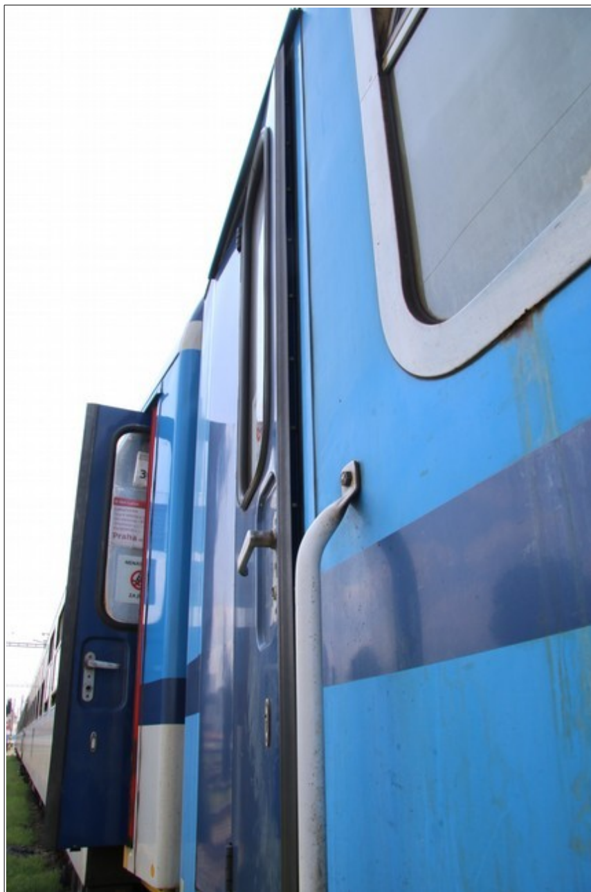
Obr. č. 7: Pohled na neuzavřené/neúplně dovřené pravé zadní ND TDV 51 54 82-40 377-8 s vnější klikou směřující šikmo dolů pod úhlem -15^\circ a pryžovým lemem křídla ND těsně nedoléhajícím k pryžovému lemu rámu dveří.
