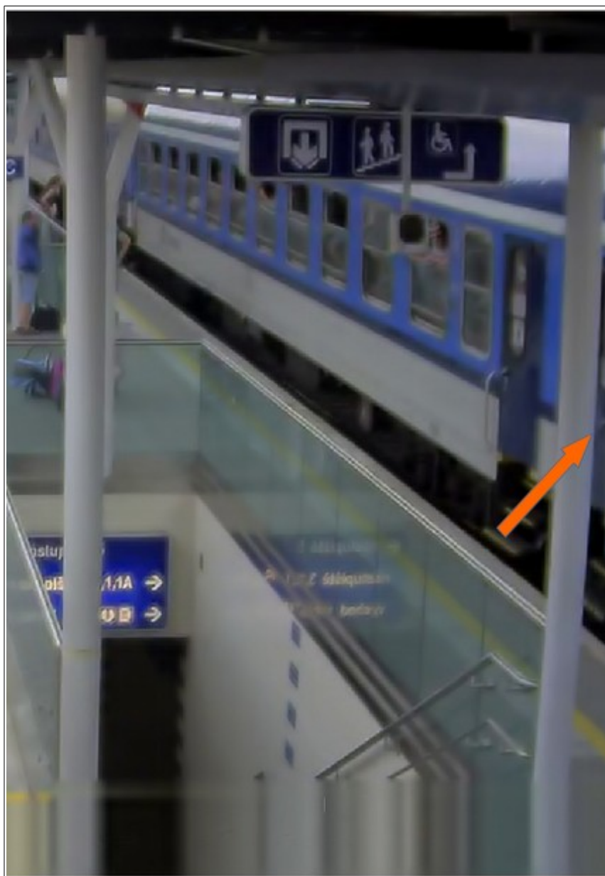
Obr. č. 6: Pohled na neuzavřené/neúplně dovřené pravé zadní ND TDV 51 54 82-40 377-8, jejichž vnější klika směřuje šikmo dolů pod úhlem (mezi vodorovnou rovinou a osou kliky) cca -15^\circ , v době po rozjezdu vlaku R 884 od nástupiště č. 4 žst. Olomouc hl. n., kdy vlak dosáhl rychlosti 19 \text{ km}\cdot\text{h}^{-1} . Zdroj: SŽDC, s. o.
