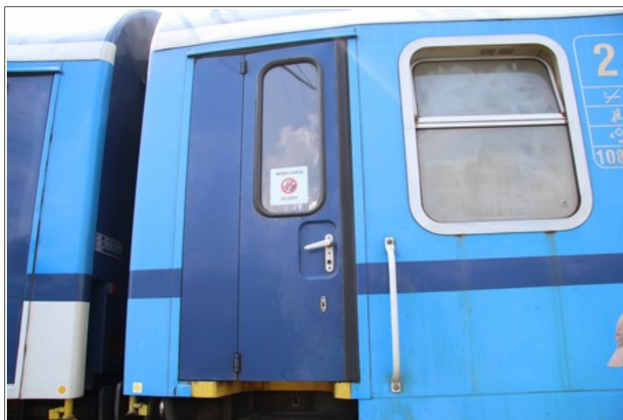
Obr. č. 1: Pohled na přivřené, neuzavřené/neúplně dovřené, nástupní dveře (ND) TDV CZ-ČD 51 54 82-40 377-8. Zdroj: DI
