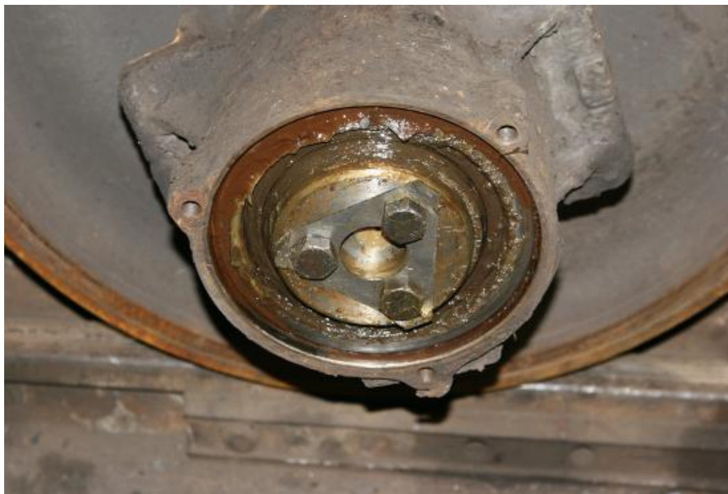
Obr. č. 8: Stav jedné z ostatních ložiskových komor TDV nezasažené nehodovým dějem Zdroj: DI
