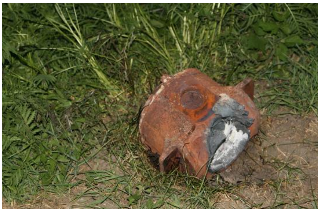
Obr. č. 5: Odpadlý ložiskový domek, stav při nalezení
