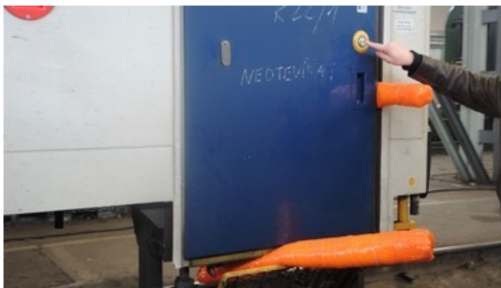
Obr. č. 17: Zavírání dveří jízdou vozidla - zkouška C1 Zdroj: DI
