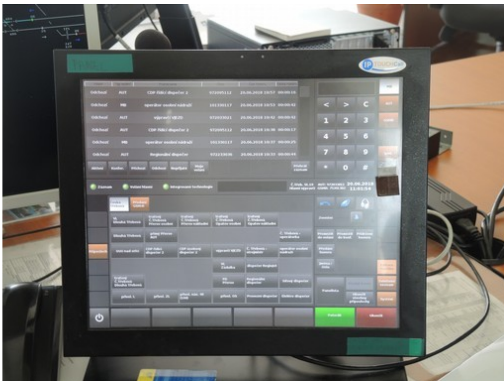
Obr. č. 19: LCD displej integrovaného zapojovače IPTC v DK Česká Třebová
