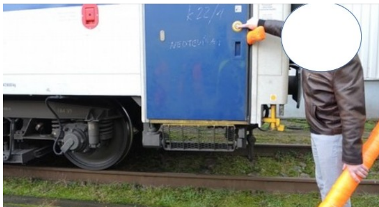
Obr. č. 15: Zavírání dveří s překážkou – zkouška B1 Zdroj: DI
