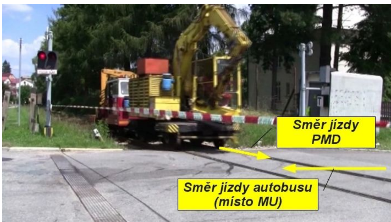
Foto 3: Pokud dojde k vyvolání výstrahy na přejezdu najetím DV na izolovaný styk anulačního obvodu přejezdu, nachází se již čelo DV v prostoru přejezdu
