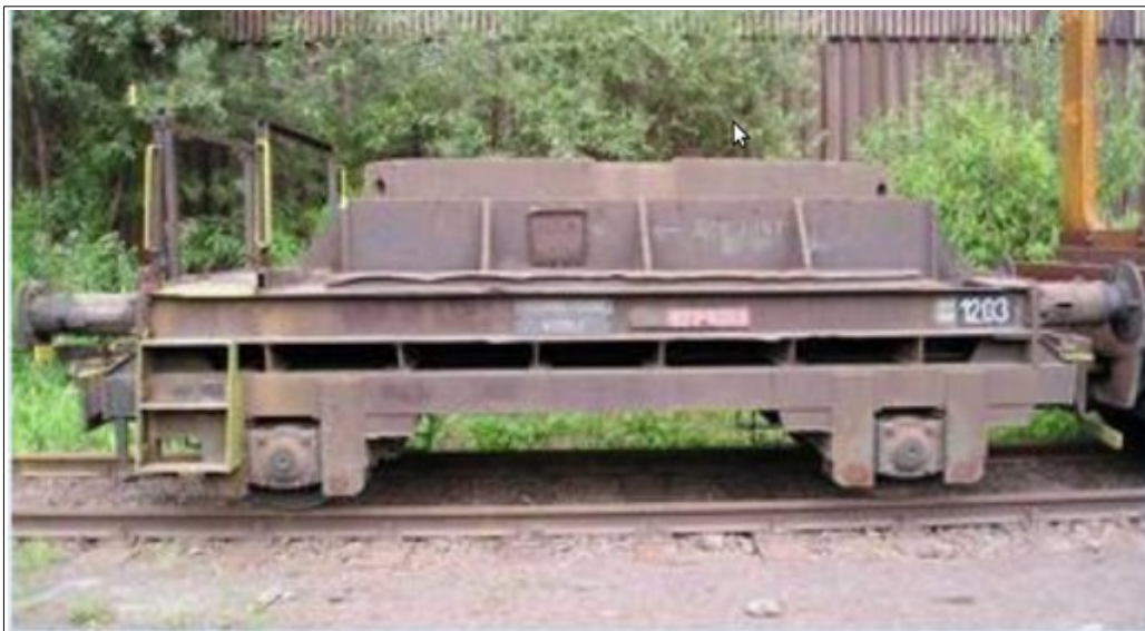
Obr. č. 3: Ochranný vůz (tzv. „mezivůz“) s ruční brzdou na ochozu. Zdroj: TŽ, a. s.
