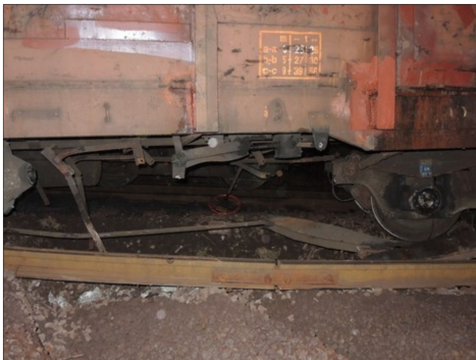
Obr. č. 3: Pohled na poškozené brzdové zařízení TDV 81 54 5972 878-9 řazeného v čele skupiny 9 TDV.
