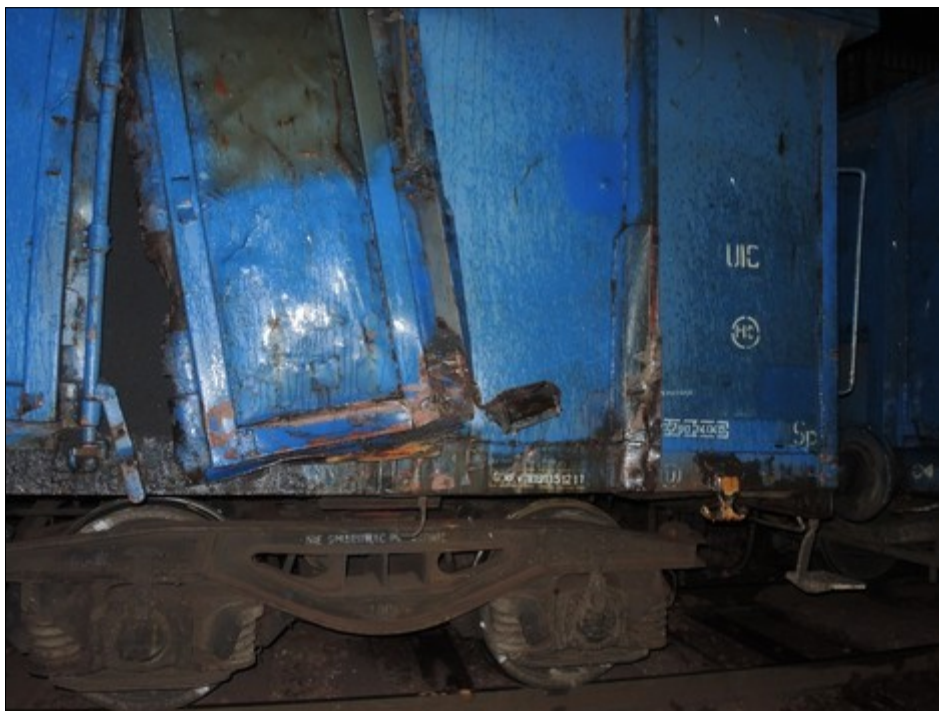
Obr. č. 5: Pohled na poškozenou vozovou skříň TDV 31 51 5355 925-9 řazeného jako v 4. TDV za HDV taženého posunového dílu PČ 13. Zdroj: DI
