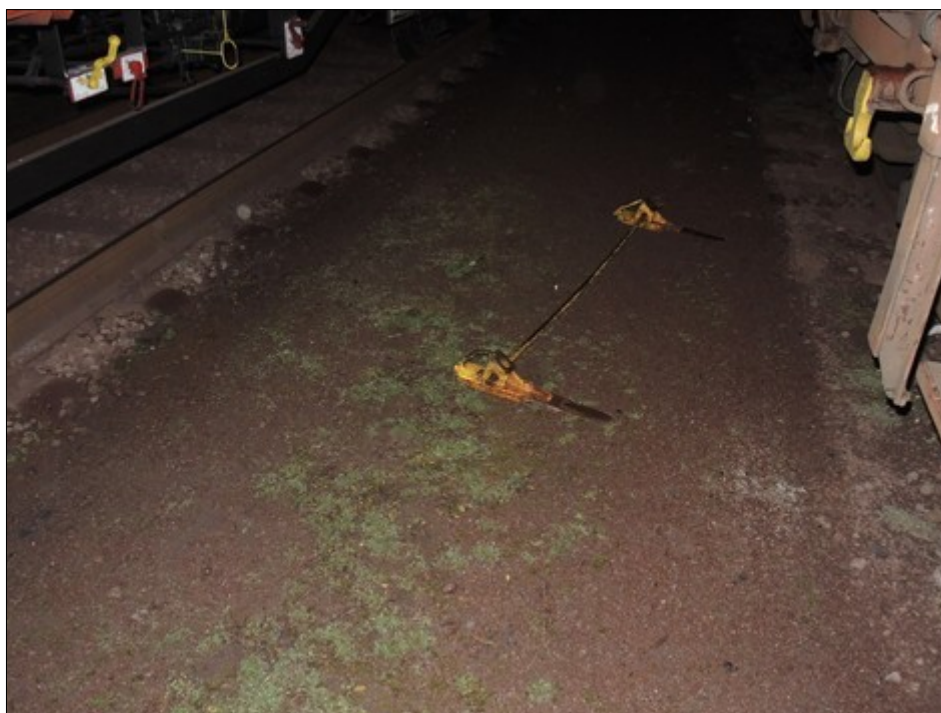
Obr. č. 6: Pohled na dvojitou zarážku volně položenou mezi kolejemi č. 1508 a č. 1509. Zdroj: DI
