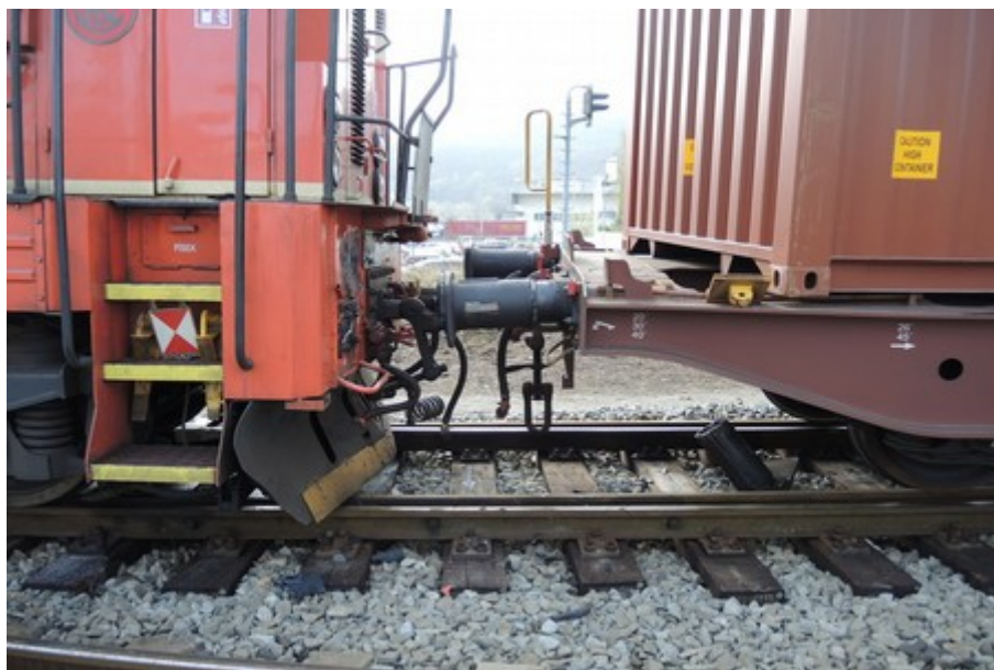
Obr. č. 3: Sražené posunové díly – vlevo HDV dopravce IDSC, vpravo DV dopravce METRANS
