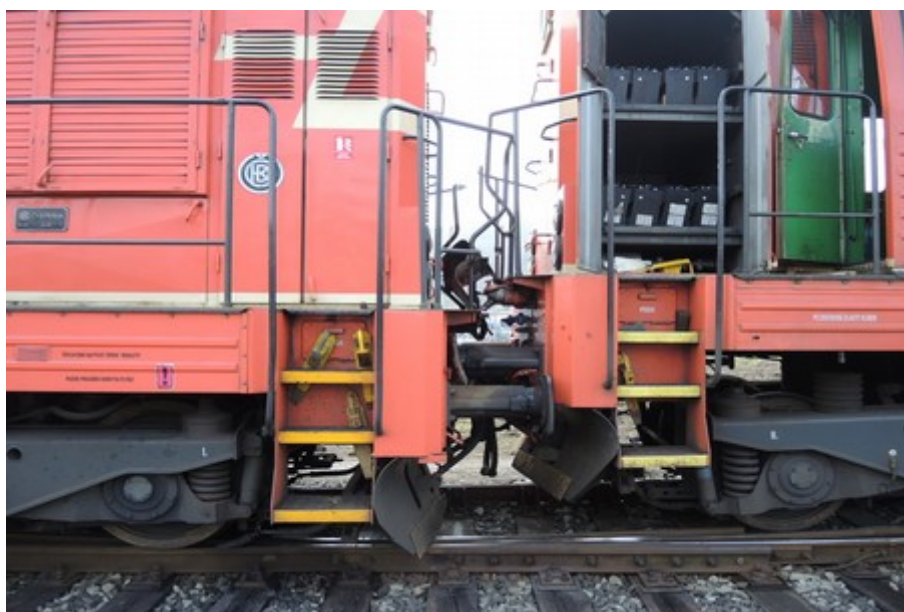
Obr. č. 6: Poškozená HDV dopravce IDSC
