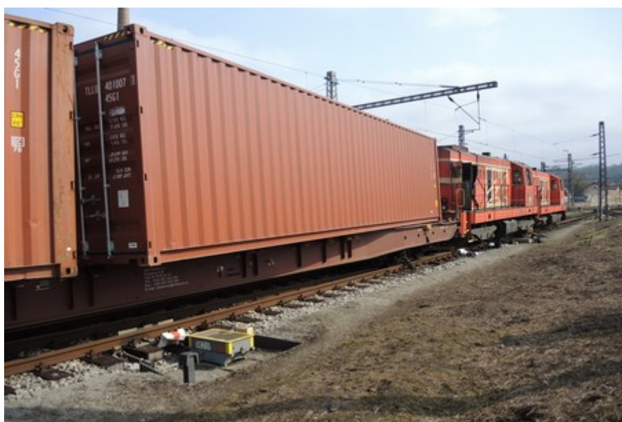
Obr. č. 4: Pohled na posunuté kontejnery
