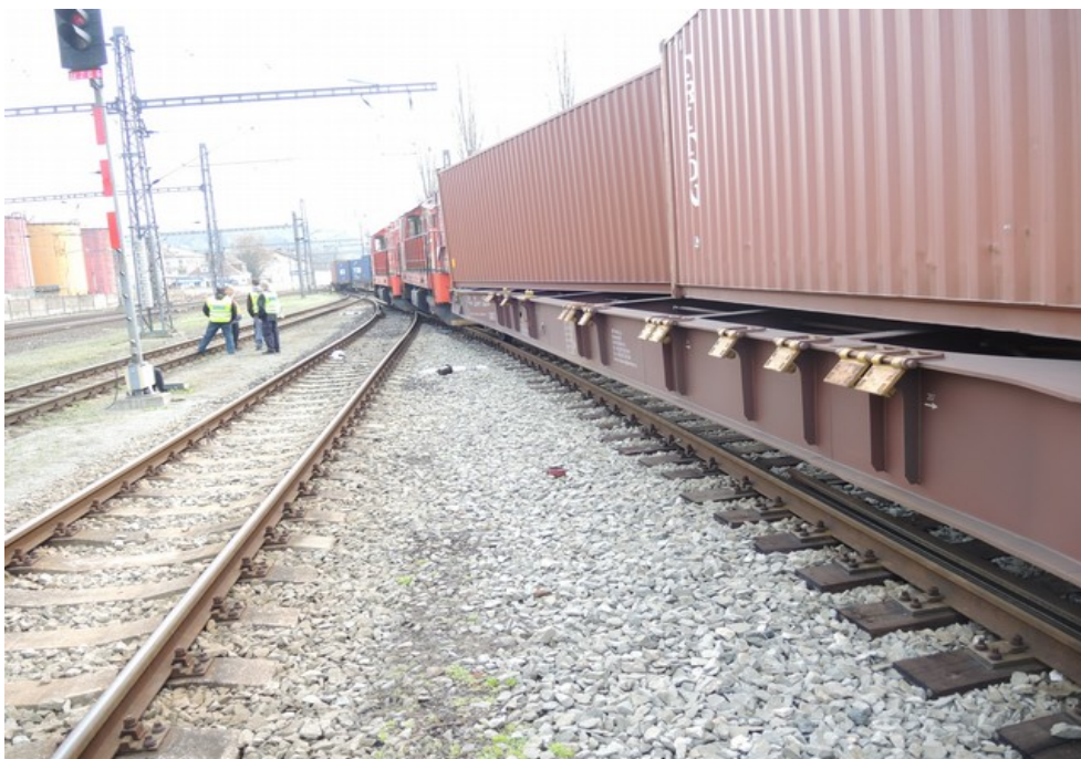
Obr. č. 12: Pohled na sražené posunové díly a posunuté kontejnery Zdroj: DI
