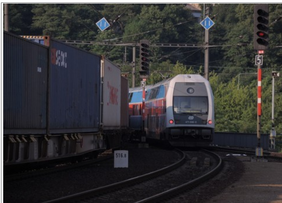
Obr. č. 6: DV vlaků Nex 43333 a Os 6905 v konečném postavení po MU, vč. cestových návěstidel Sc1 a Sc3 (pohled z prostoru 2. nástupiště).
