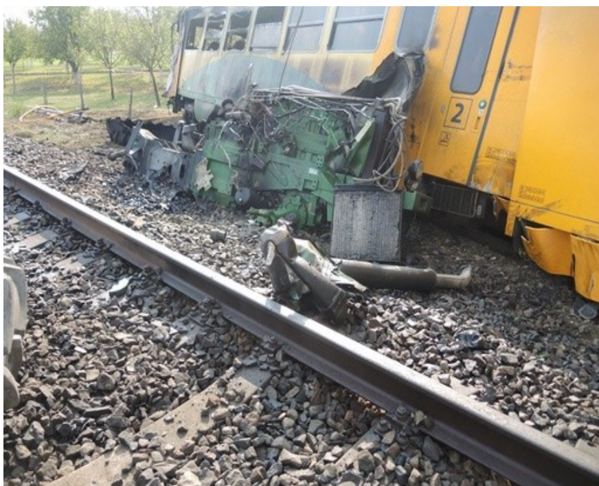
Obr. č. 6: Přední motorová část traktoru a HDV v čele vlaku Os 2710 Zdroj: Dražní inspekce
