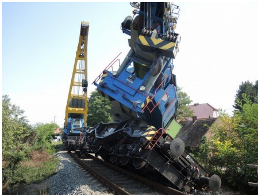
Obr. č. 11: Vykolejení jeřábu EDK 750.1 a přívěsného vozíku při odstraňování následků nehody na přejezdu
