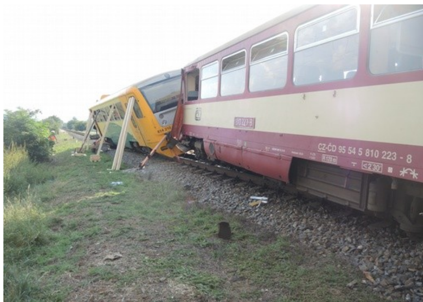
Obr. č. 4: Poslední a předposlední vykolejené HDV vlaku Os 2710
