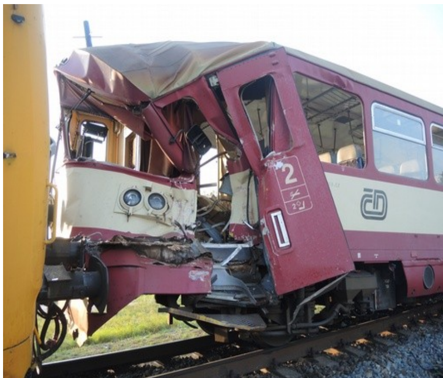
Obr. č. 5: Návěsem zdemolované čelo posledního HDV soupravy vlaku Os 2710 Zdroj: Dražní inspekce
