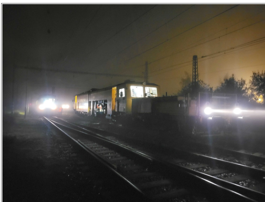
Obr. č. 2: Vzdálenost čel obou vlaků po jejich zastavení
