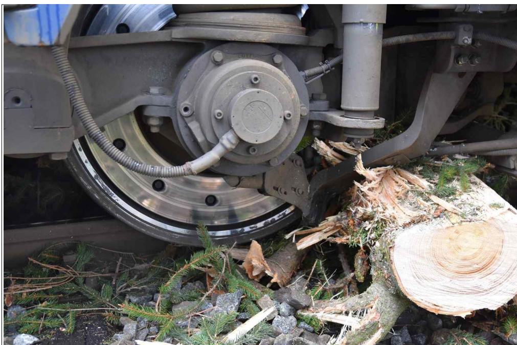
Obr. č. 4: Pohled na vykolejenou první nápravu prvního podvozku ve směru jízdy vlaku. Zdroj: DI
