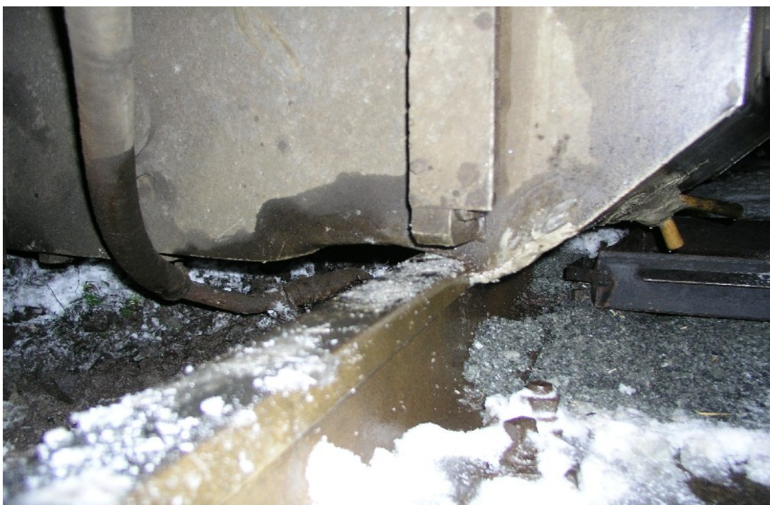
2. Pohled na poškozenou nádrž pohonných hmot HDV řady 742.126-6
